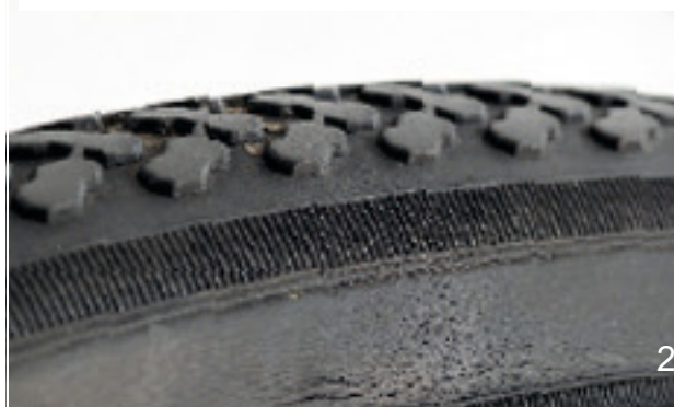
157. ábra: Példák kifáradási repedésekre (1) és öregedési repedésekre (2)
