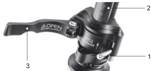
146. ábra: A kormányszár-gyorszár (3) nyitott gyorskioldója a kormányszáron (2), I kivitel, a kormányszáron (1) lévő rögzítőkarral
