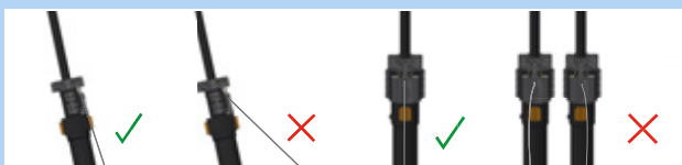
196. ábra: Helyesen és hibásan beállított bovdent
