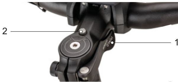
147. ábra: II kivitelű kormányoszár a kormányoszár-gyorszár (1) gyorskioldójával és reteszelésoldó gombbal (2)
