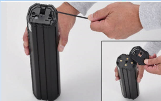
60. ábra: A felső csatlakozó felület kiszérése
