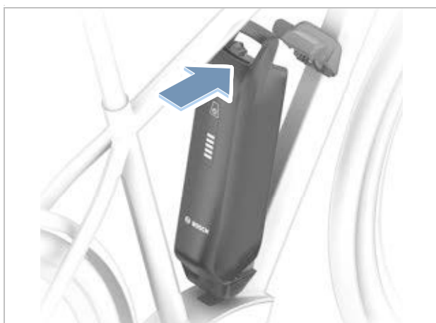
Illustration 110 : Rabattre la batterie PowerPack vers le haut
