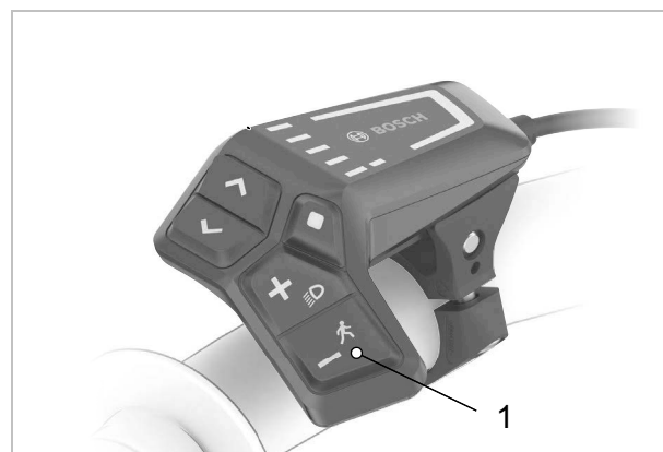
Illustration 124 : Position de la touche d'assistance de poussée (1)
