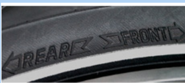
Figura 70: Flecha de sentido de la marcha en cubiertas de MTB
