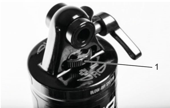
Figura 222: Rueda del regulador de niveles de tracción SR SUNTOUR (1) en el amortiguador de la horquilla trasera
