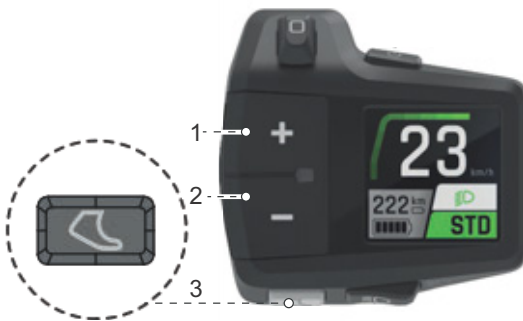
Figura 154: Posición del botón + (1), del botón - (2) y del botón de ayuda para el desplazamiento (3)
