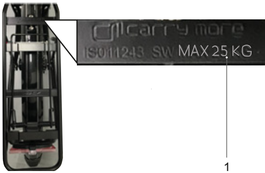
Figura 145: En el portaequipajes se indica la capacidad máxima de carga (1)
