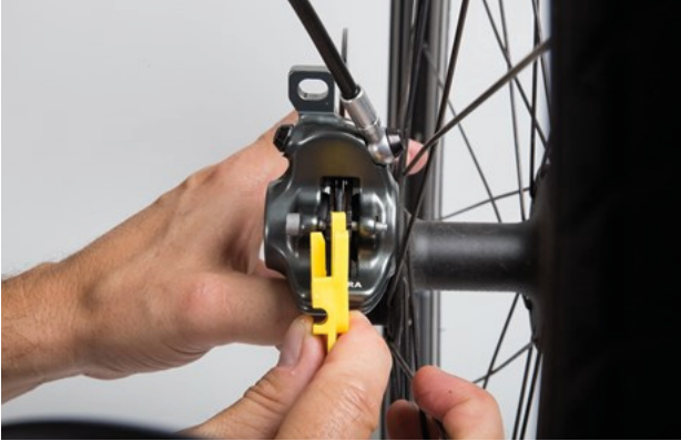
Figura 170: Comprobación de la almohadilla de freno montada con ayuda del seguro de transporte
