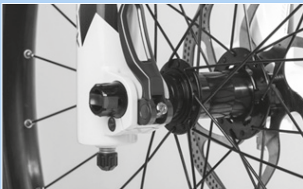
Figura 79: Posición perfecta de la palanca tensora
