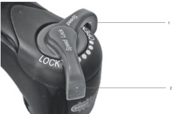
Figura 210: Ajuste para un regulador de niveles de presión más blando
