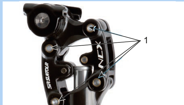
Figura 201: Puntos de lubricación de la tija de sillín de muelle SR SUNTOUR
