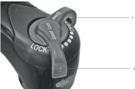
Figura 208: Ajuste para un regulador de niveles de presión más duro
