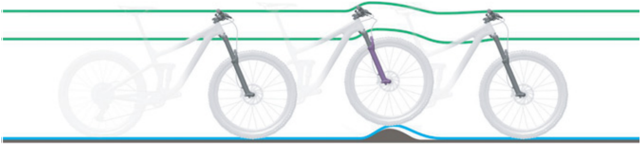
Figura 217: Amortiguación de la horquilla de suspensión demasiado dura en caso de irregularidades
