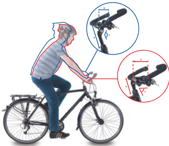
Figura 120: Posición de la bicicleta de ciudad (azul) y la bicicleta de trekking (rojo) mediante la modificación angular
