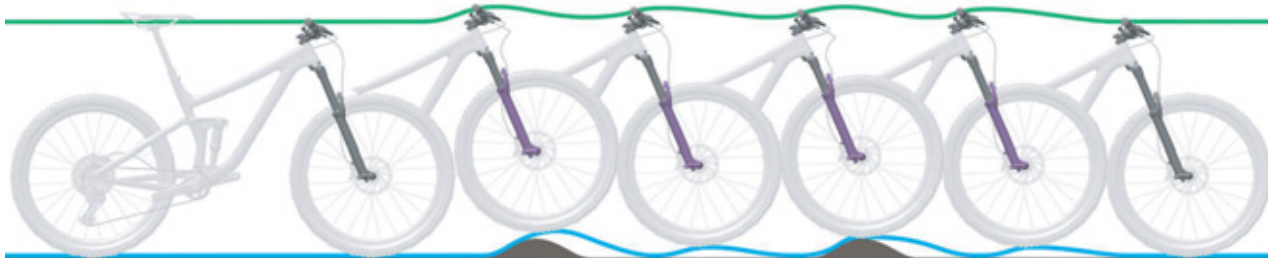
Figura 203: Descompresión demasiado rápida de la horquilla de suspensión
