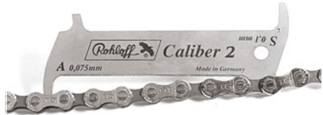
Figura 176: Ejemplo de calibre de medición ROHLOFF
