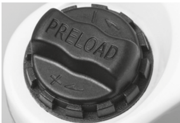
Figur 56: Indstillingshjulet til den negative fjedervandring på fjedergaflens krone
