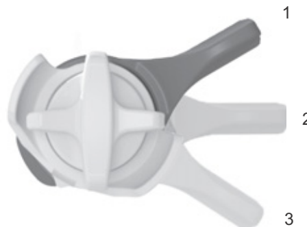
Figur 73: FOX-trykindstillingsanordning på bagdæmper med positionerne ÅBEN (1), MELLEME (2) og HÅRD (3)
