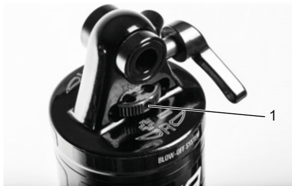
Figur 60: Hjul (1) for Suntour-træktrinsindstillingsanordning på bagdæmperen
