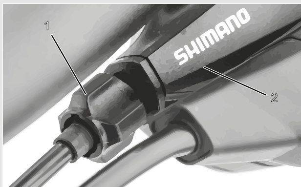
Figur 85: Slutmuffe (1) på gearskiftet med ét kabel og gearvælgerhus (2), eksempel
