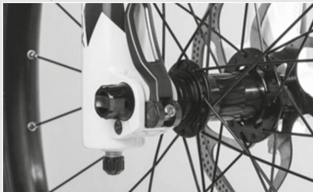
Figur 83: Indstilling af hurtigbespændingens spændekraft
