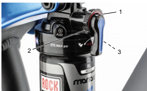
Figur 78: Indstilling af trækdæmperens hårdhed på bagdæmperens indstillingshjul (1)
