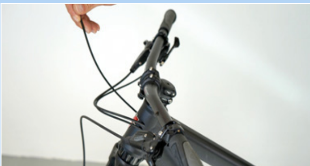
Illustration 210 : Accrocher le capuchon d'extrémité
