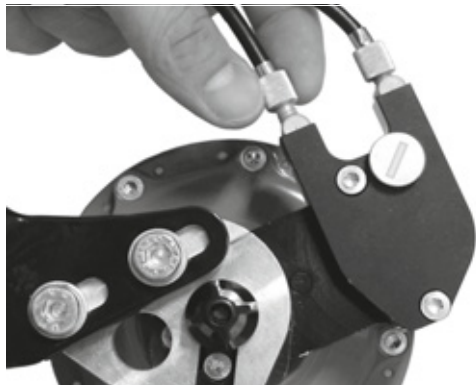
Illustration 144 : Sur les versions de moyeux ROHLOFF avec commande externe du changement de vitesse, le dispositif de réglage de la tension est situé sur le boîtier de câbles qui est placé sur le côté gauche.
