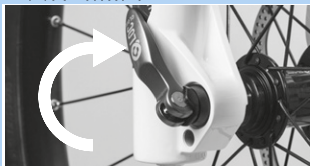
Illustration 68 : Fermer l'attache rapide
