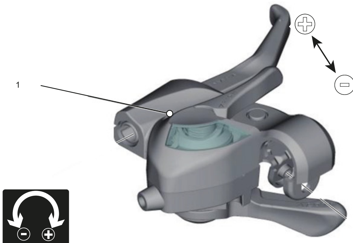
Illustration 99 : Position de la vis de réglage (1)
