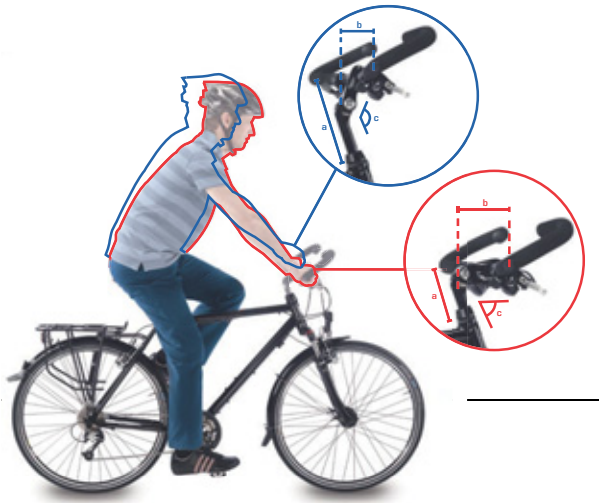
Illustration 89 : Position sur vélo de ville (en bleu) et sur vélo tout chemin (en rouge) avec modification de l'angle
