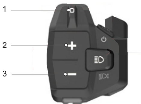
Illustration 112 : Position du bouton à bascule de navigation (1) et des touches Plus (2) et Moins (3)
