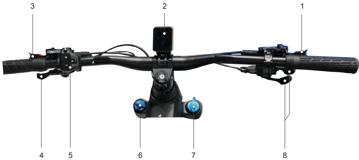
Illustration 35 : Vue détaillée d'un guidon avec ordinateur de bord SHIMANO SC-E800, exemple
