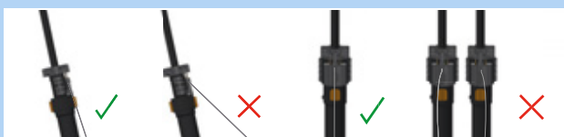
Illustration 178 : Câble Bowden correct et incorrect
