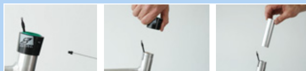
Illustration 193 : Démonter l'enveloppe extérieure et la douille de glissement
