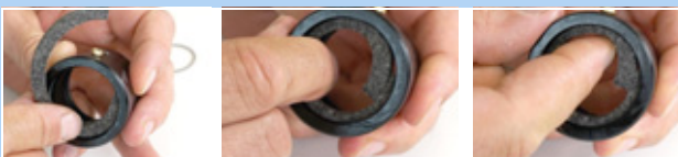
Illustration 199 : Insérer l'anneau de feutre
