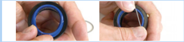
Illustration 200 : Insérer et fixer le joint anti-poussière
