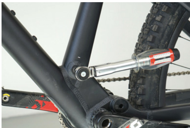
Illustration 75 : Serrer l'axe de la tige de selle
