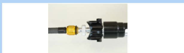
Illustration 169 : Pomper de l'air dans la cartouche
