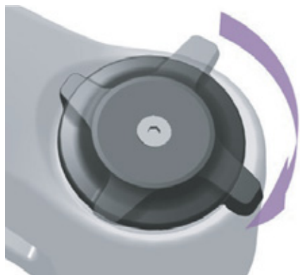
Illustration 78 : Régler le dispositif de réglage de la compression sur un niveau plus dur
