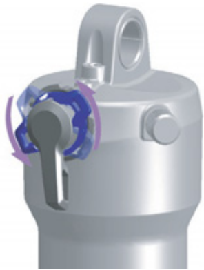
Illustration 104 : Régler le dispositif de réglage de la compression sur un niveau plus souple
