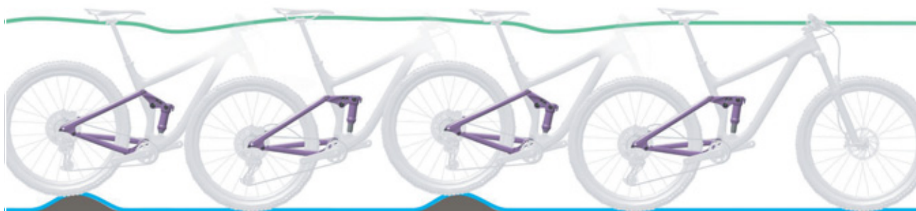
Illustration 62 : Comportement optimal de l'amortisseur arrière
