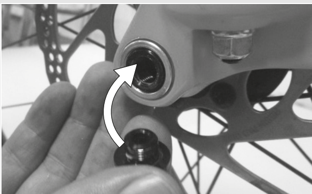
Illustration 24 : Enfoncer le levier d'attache rapide dans l'axe
