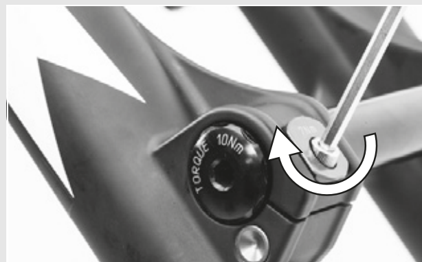
Illustration 27 : Serrer le collier de blocage
