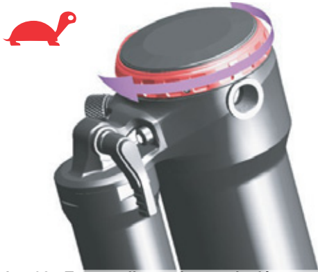
Illustration 98 : Tourner l'amortisseur de détente vers la tortue
