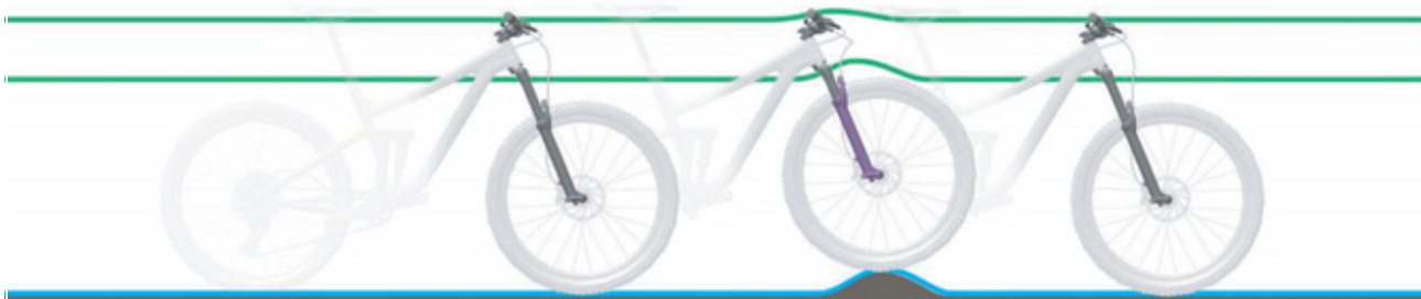
Illustration 76 : Comportement optimal sur les irrégularités
