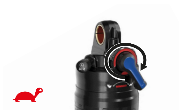
Illustration 66 : Réduire la vitesse de détente
