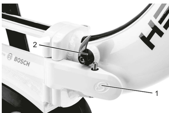
Abbildung 73: Rahmen, mit geschlossenem Rahmen-Spannhebel (1) und geöffnetem Rahmen-Sicherungshebel (2)
