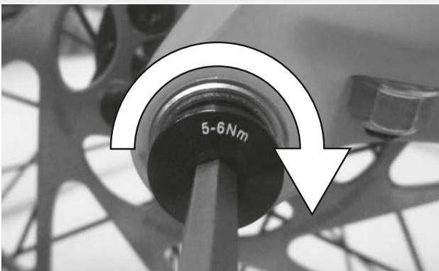
Abbildung 31: Sicherungsschraube anziehen
