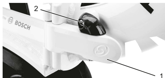
Abbildung 74: Rahmen, mit geschlossenem Rahmen-Spannhebel (1) und geschlossenem Rahmen-Sicherungshebel (2) Pedal auseinanderfalten
