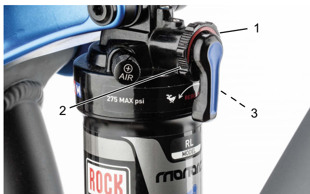
Abbildung 90: Härte des Zugstufen-Dämpfers am Einstellrad (1) des Hinterbau-Dämpfers einstellen
