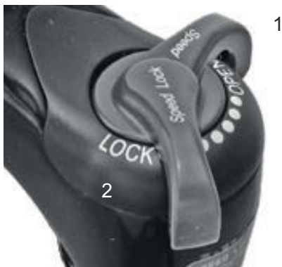
Abbildung 87: Suntour-Druckstufeneinsteller mit den Positionen OPEN (1) und LOCK (2)
