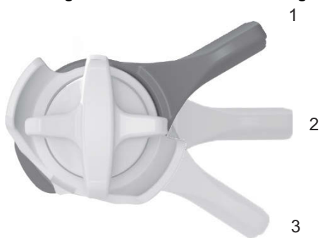
Abbildung 85: FOX-Druckstufeneinsteller am Hinterbau-Dämpfer mit den Positionen OFFEN (1), MITTEL (2) und HART (3)
