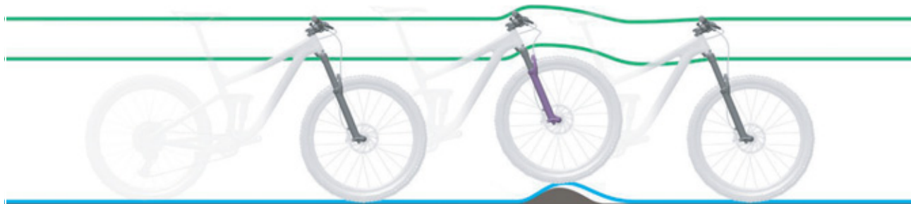
Rysunek 76: Zbyt twarde tłumienie widelca amortyzowanego na nierównościach
