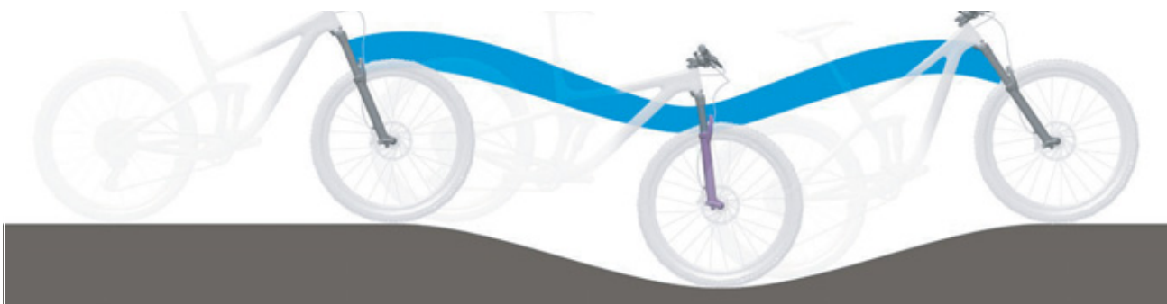
Rysunek 6: Optymalne działanie widełca na pagórkowatym terenie
