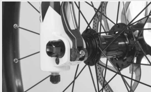
Rysunek 65: Ustawianie siły mocowania zacisku szybko mocującego
