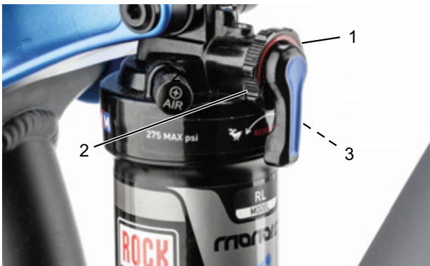
Figura 68: Ajuste de la dureza del amortiguador de niveles de tracción en la rueda de ajuste (1) del amortiguador de la horquilla trasera
