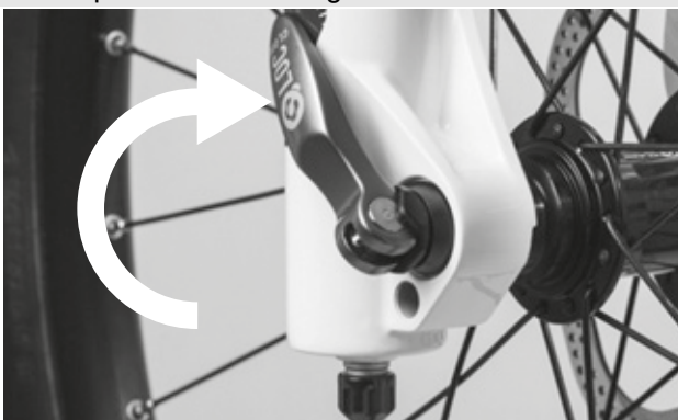
Figura 35: Cierre del cierre rápido
