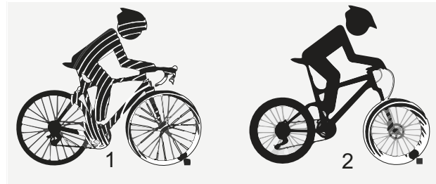
Figura 4: Pedelec sin suspensión (1) y con suspensión (2) en caso de conducción sobre obstáculo
