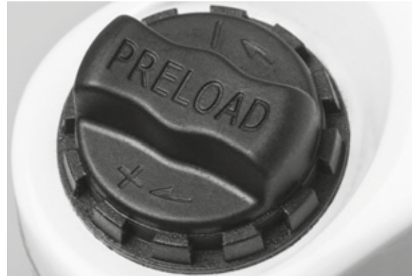
Figura 52: Rueda de ajuste del recorrido de muelle negativo en la corona de la horquilla de suspensión
