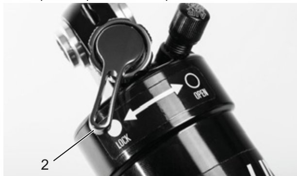
Figura 67: Regulador de niveles de presión Suntour cerrado (2)
