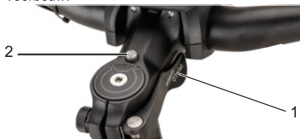
Afbeelding 72: Voorbouw, uitvoering II met spanhendel van de snelspanner van de voorbouw (1) en deblokkeringsknop (2)
