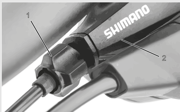
Afbeelding 97: Afstelwartel (1) van de versnelling met enkele bowdenkabelbediening en behuizing van de schakelhendel (2), voorbeeld
