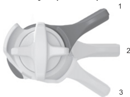
Afbeelding 85: FOX-drukdemperafsteller op de achterbouwdemper met de standen OPEN (1), MIDDEL (2) en HARD (3)
