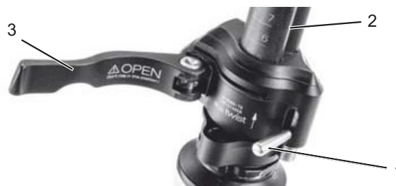
Afbeelding 71: Geopende spanhendel van de snelspanner (3) op de voorbouw (2), uitvoering I, met vergrendelhendel (1) op de voorbouw
