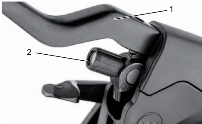
**Figura 28:** Leva del freno (1) del freno a pattino ad azionamento idraulico con vite di regolazione (2)
