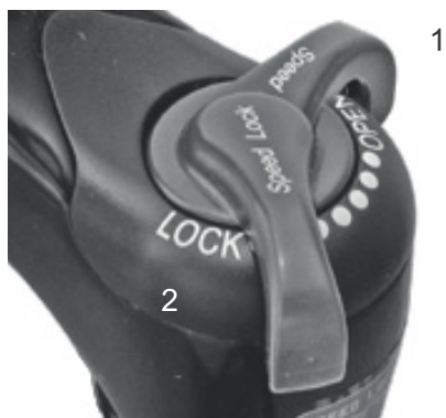
Afbeelding 64: Suntour-drukdemperafsteller met de standen OPEN (1) en LOCK (2)
