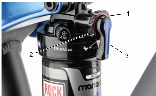
Afbeelding 67: Hardheid van de trekdemper afstellen met het afstelwiel (1) van de achterbouwdemper
