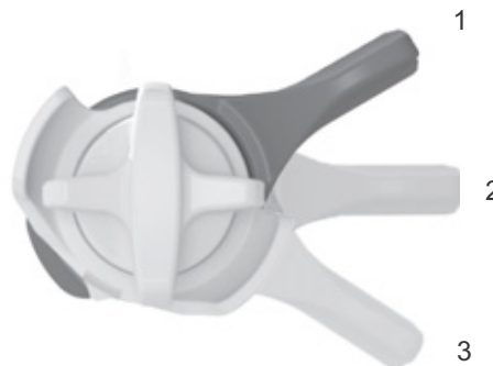
Afbeelding 62: FOX-drukdemperafsteller op de achterbouwdeemper met de standen OPEN (1), MIDDEL (2) en HARD (3)
