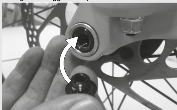
Afbeelding 22: Snelspanhendel in as schuiven
