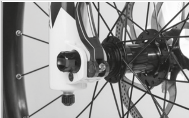
Afbeelding 30: Perfecte stand van de spanhendel
