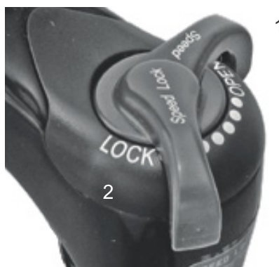
Figur 76: Suntour-trykindstillingsanordning med positionerne OPEN (1) og LOCK (2)
