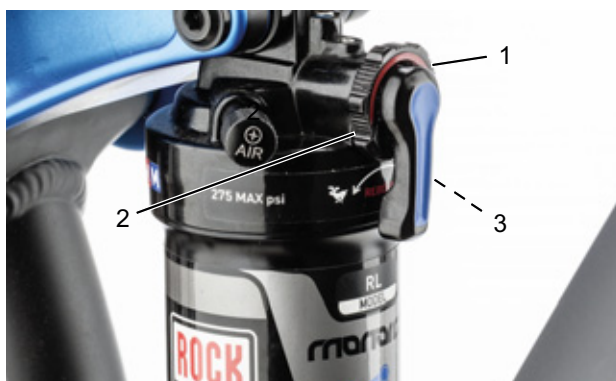
Figur 79: Indstilling af trækdæmperens hårdhed på bagdæmperens indstillingshjul (1)
