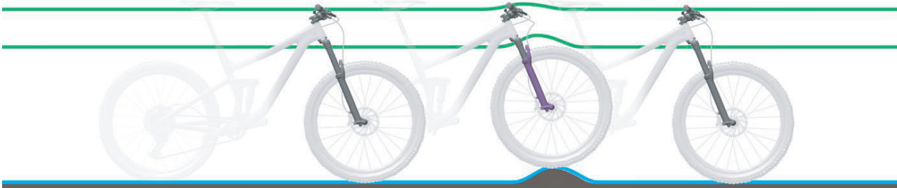
Abbildung 6: Optimales Fahrverhalten der Gabel bei Unebenheiten
