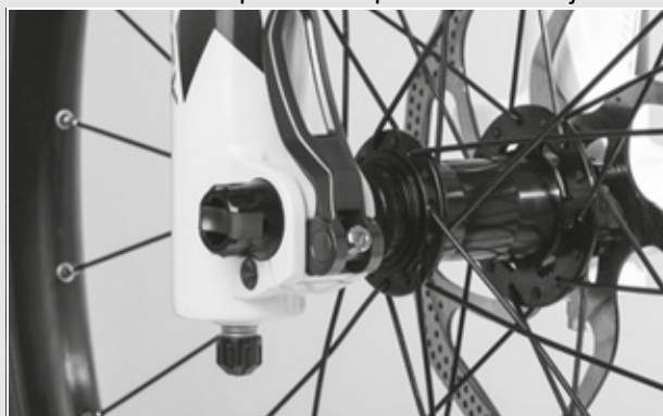
Afbeelding 35: Perfecte stand van de spanhendel
