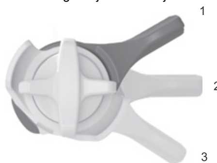
Afbeelding 78: FOX-drukdemperafsteller op de achterbouwdemper met de standen OPEN (1), MIDDEL (2) en HARD (3)
