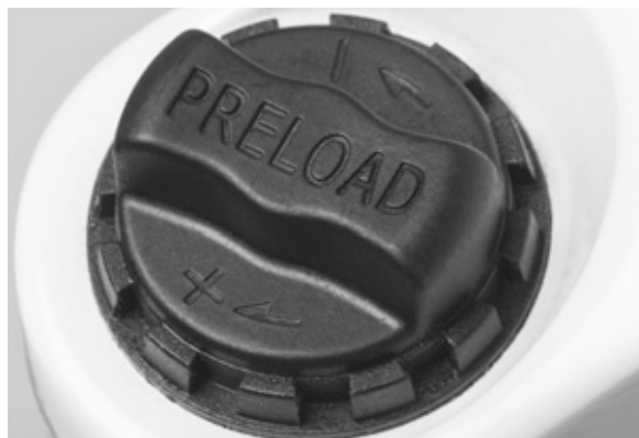
Afbeelding 57: Afstelwiel voor de negatieve veerweg op de kroon van de verende voorvork
