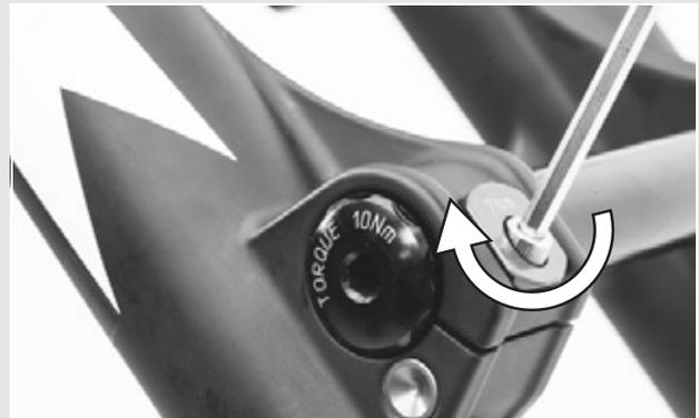
Figura 29: Serraggio del perno
