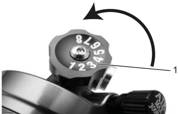
Figura 61: Regolatore della compressione Suntour sull'ammortizzatore del carro posteriore
