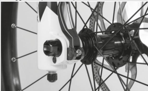
Figura 34: Corretta posizione della leva di serraggio
