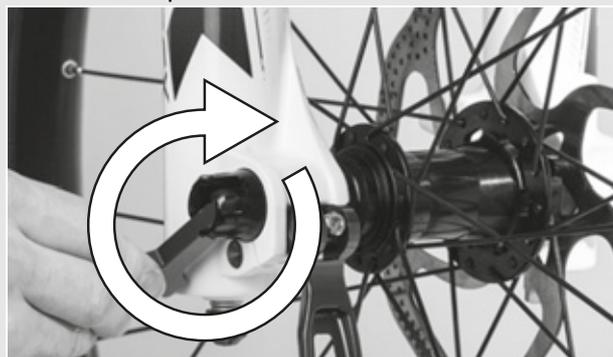
Figura 31: Serraggio del perno
