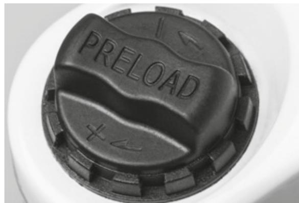
**Figura 57: Manopola di regolazione dell'escursione negativa della sospensione sulla corona della forcella ammortizzata**
