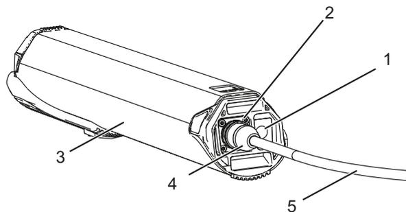
Figura 66: Unità di trazione con indicatore dello stato di carica (1), presa di ricarica (2), unità di trazione con batteria (3), spina di ricarica (4) e cavo di collegamento (5)
