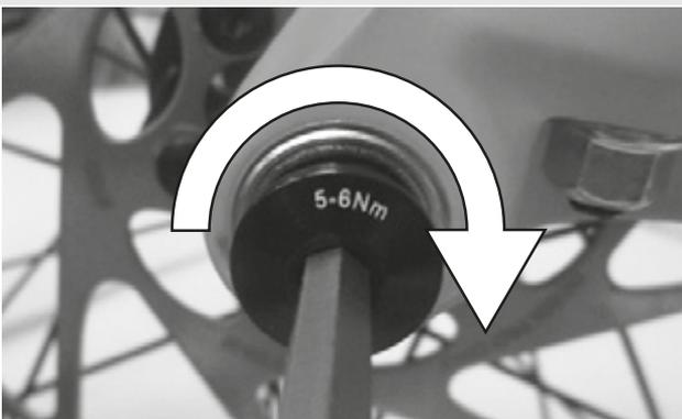
Figura 27: Serraggio della vite di sicurezza
