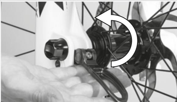
Figura 33: Bloccaggio della leva
