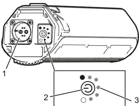
Figura 17: Batteria, vista dal lato del connettore di ricarica
