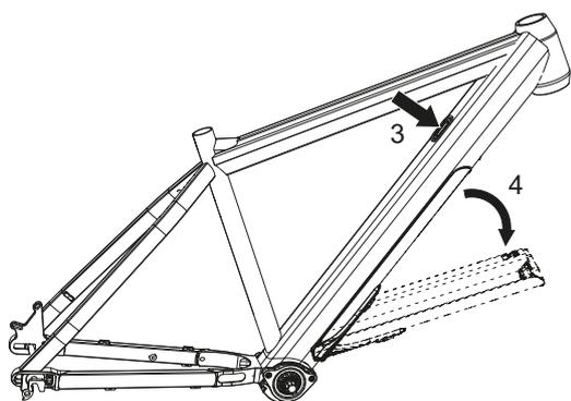
**Figura 73: Estrazione dell'unità di trazione dal pedelec**
