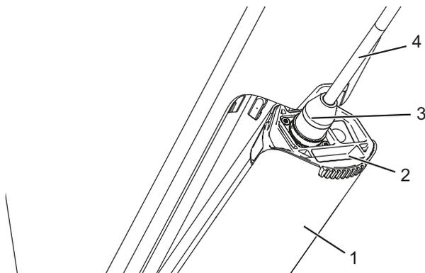
Figura 67: Unità di trazione (1) con indicatore dello stato di carica (2), spina di ricarica (3) e cavo di collegamento (4)
