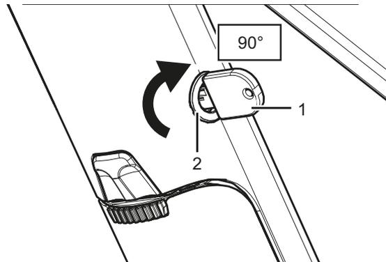
Figura 72: Sbloccaggio dell'unità di trazione
