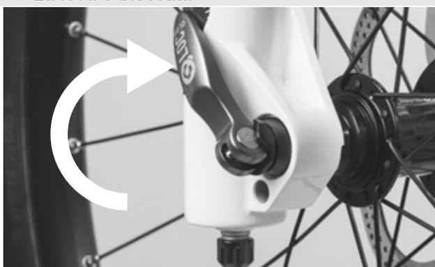
Figura 39: Chiusura del bloccaggio rapido
