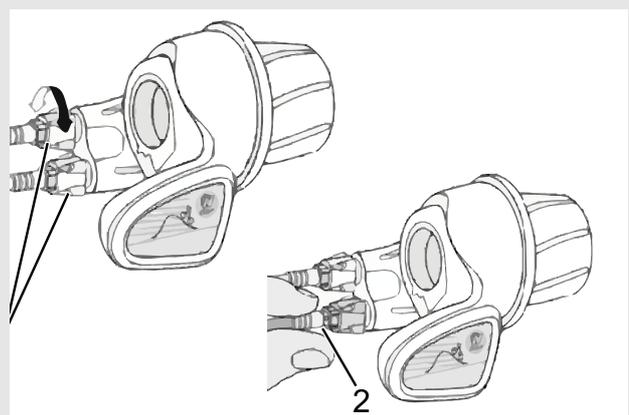
Figura 86: Interruttore a manopola del cambio con boccole di regolazione (1) e gioco della boccola del cambio (2)
