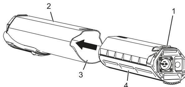
Figura 68: Montaggio della batteria nell'unità di trazione
