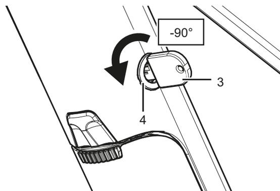
Figura 71: Chiusura a chiave dell'unità di trazione
