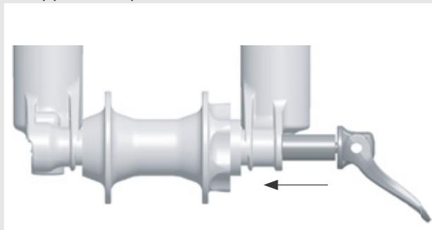
Figura 40: Inserimento del bloccaggio rapido
