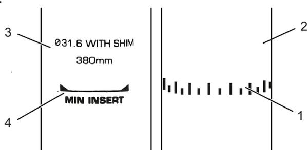
Figura 47: Particolare dei canotti reggisella, esempi di segno indicante la minima profondità di inserimento
