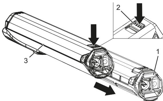
Figura 69: Estrazione della batteria dall'unità di trazione
