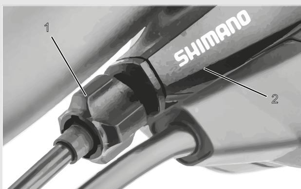
Figura 84: Boccola di regolazione (1) del cambio azionato da cavo singolo con scatola della leva del cambio (2), esempio
