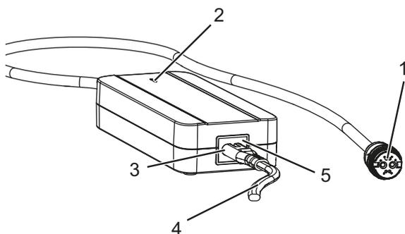
Figura 65: Caricabatterie con spina di rete (1), indicatore a LED caricabatterie (2), spina dell'alimentatore (3), cavo di collegamento (4) e presa elettrica (5)
