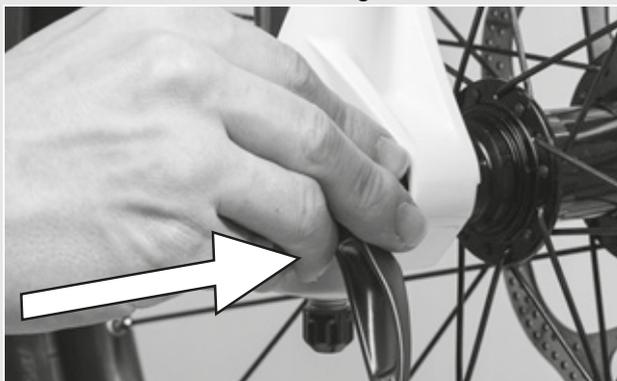
Figura 37: Inserimento del bloccaggio rapido
