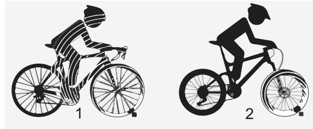
Figura 4: Pedelec senza sospensione (1) e con sospensione (2) nel passaggio su un ostacolo
