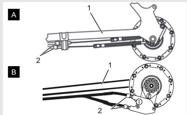
Figura 85: Boccole di regolazione (2) di due versioni alternative (A e B) di un cambio azionato da cavo doppio sul fodero orizzontale (1)
