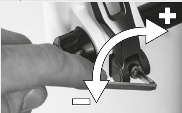
Figura 35: Regolazione della forza di serraggio del bloccaggio rapido
