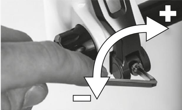
Figura 83: Regolazione della forza di serraggio del bloccaggio rapido
