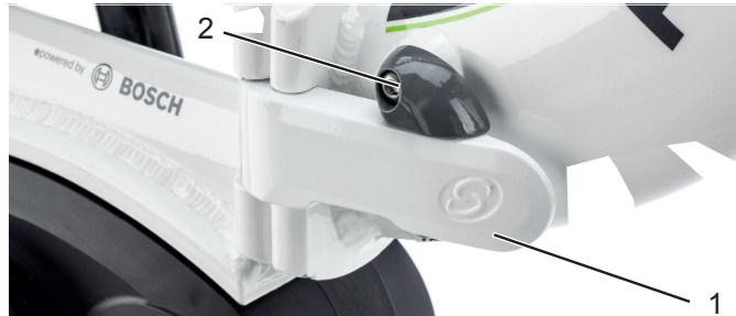
Abbildung 47: Rahmen, mit geschlossenem Rahmen-Spannhebel (1) und geschlossenem Rahmen-Sicherungshebel (2)
