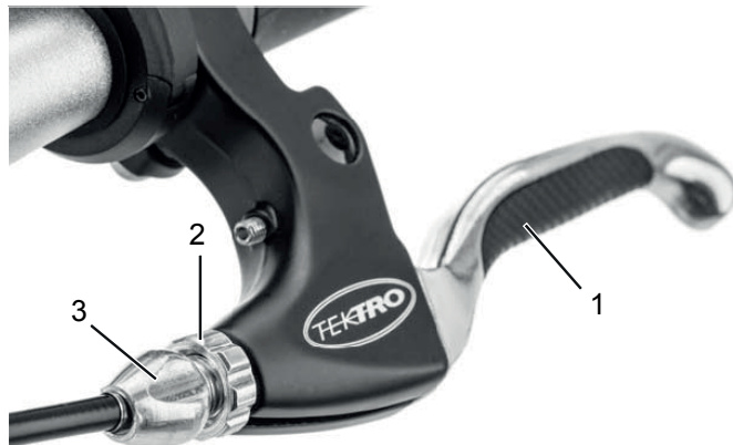
Abbildung 65: Bremshebel (1), Kontermutter (2) und Einstellschraube (3) der seilzugbetätigten Felgenbremse
