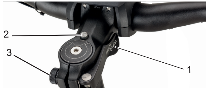
Abbildung 24: Vorbau, Ausführung II mit Spannhebel (1), Entsperrknopf (2) und Rändelmutter (3)
