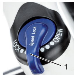
Abbildung 35: Gabelsperre am Federgabelkopf mit Sperrhebel (1), Beispiel
