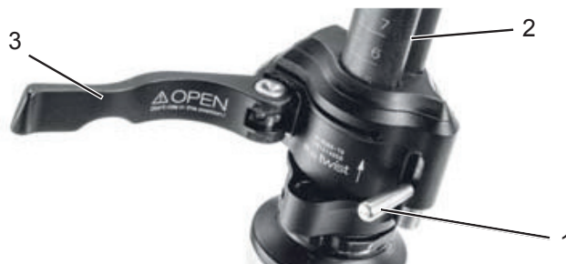
Abbildung 44: Geöffneter Spannhebel des Vorbau-Schnellspanners (3) am Vorbau (2), Ausführung I, mit Sicherungshebel am Vorbau (1)
