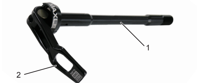
Abbildung 55: Schnellspanner, Ausführung V, mit Achse (1) und Spannhebel (2)
