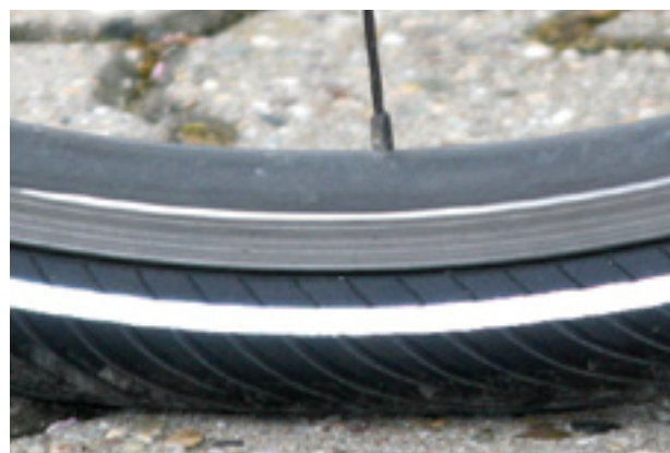
Rysunek 122: Prawidłowe ciśnienie w oponach. Opona prawie nie odkształca się pod wpływem ciężaru ciała
