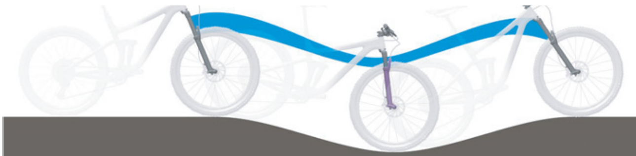
Rysunek 215: Zbyt miękkie amortyzowanie widelca na wzniesieniu
