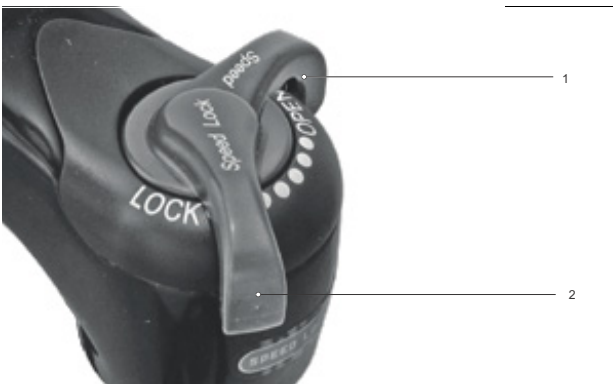
Rysunek 208: Ustawienie nastawnika dobicia na twardszy tryb pracy
