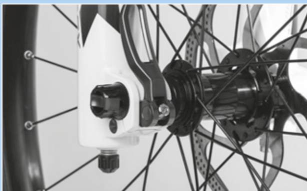
Rysunek 79: Optymalne położenie dźwigni mocującej
