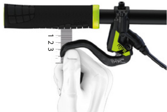
Rysunek 127: Ustawienie hamulca ręcznego
