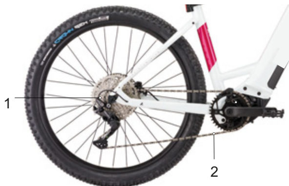
Rysunek 37: Schemat napędu łańcuchowego z przerzutką
