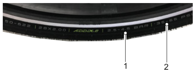
Rysunek 167: Ciśnienie w oponach w barach (1) i psi (2)
