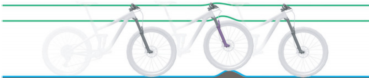
Rysunek 11: Optymalne działanie widełca podczas jazdy po nierównościach
