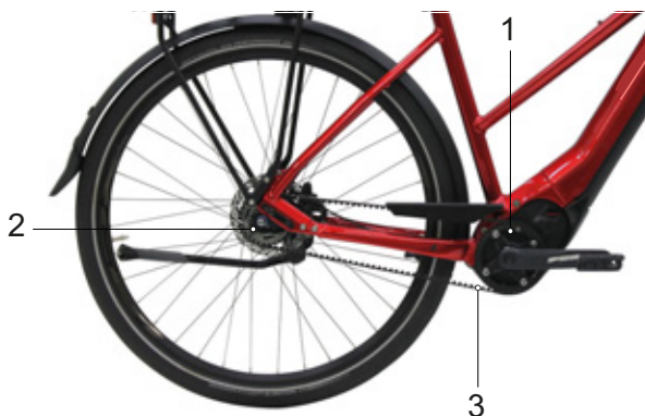
Rysunek 38: Schemat napędu paskowego
