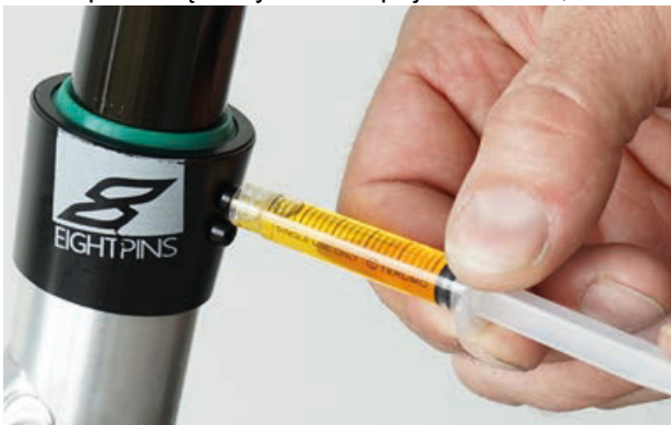
Rysunek 166: Smarowanie sztycy podsiodłowej eightpins
