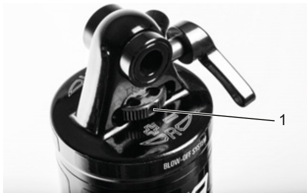
Rysunek 220: Nastawnik odbicia SR SUNTOUR – pokrętło (1) na tylnym amortyzatorze
