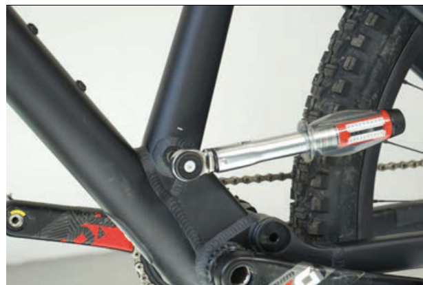
Rysunek 106: Dociąganie osi sztycy podsiodłowej
