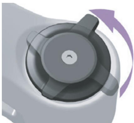
Rysunek 218: Wyregulować nastawnik dobicia tak, aby amortyzator był bardziej miękki
