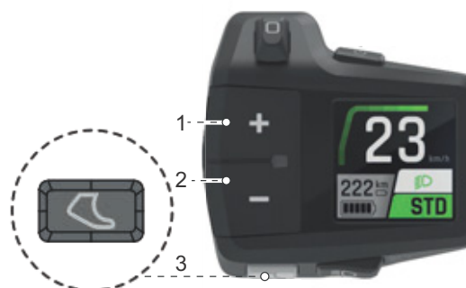
Rysunek 154: Położenie przycisków Plus (1), Minus (2), i mechanizmu wspomagającego pchanie (3)
