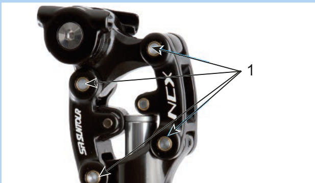
Rysunek 201: Punkty smarowania amortyzowanej sztycy podsiodłowej SR SUNTOUR
