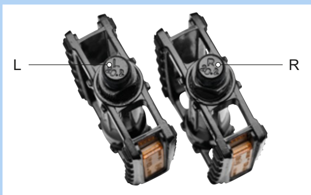
Rysunek 90: Przykład oznakowania pedałów
