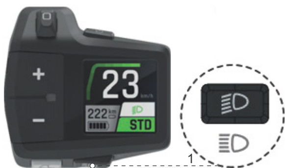
Rysunek 153: Położenie przycisku świateł do jazdy
