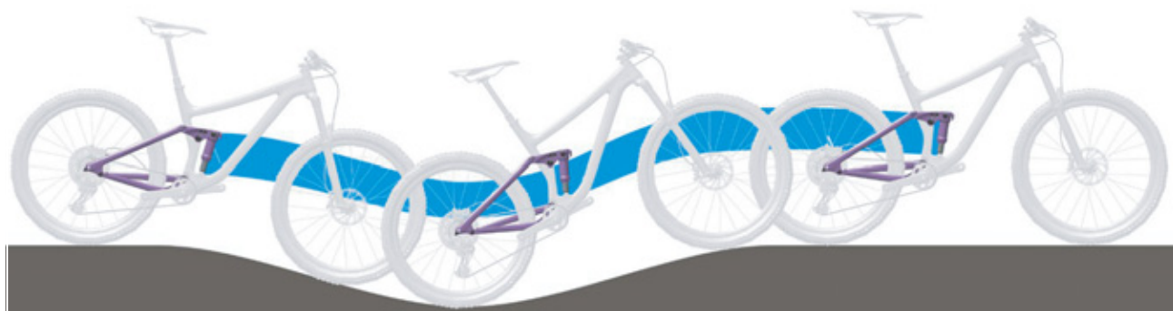
Rysunek 20: Optymalne działanie tylnego amortyzatora na pagórkowatym terenie
