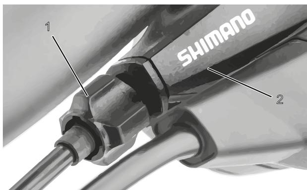
Figura 50: Boccola di regolazione (1) del cambio azionato da cavo singolo con scatola della leva del cambio (2), esempio
