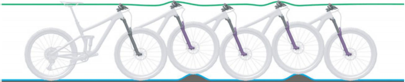
Figura 5: Comportamento di marcia ottimale della forcella
