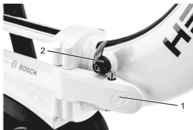
Figura 43: Leva di sicurezza del telaio chiusa (1) e aperta (2)
