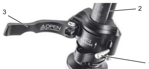
Figura 41: Leva di serraggio (3) del bloccaggio rapido dell'attacco manubrio aperta sull'attacco manubrio (2), versione I, con leva di sicurezza (1) sull'attacco manubrio
