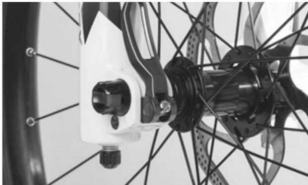
Figura 48: Regolazione della forza di serraggio del bloccaggio rapido
