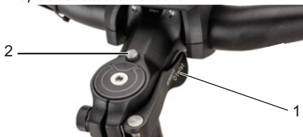
Figura 42: Attacco manubrio, versione II con leva di serraggio (1) del bloccaggio rapido dell'attacco manubrio e bottone di sbloccaggio (2)
