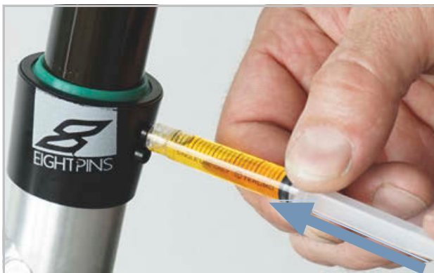
126. ábra: EIGHTPINS nyeregcső kenése
