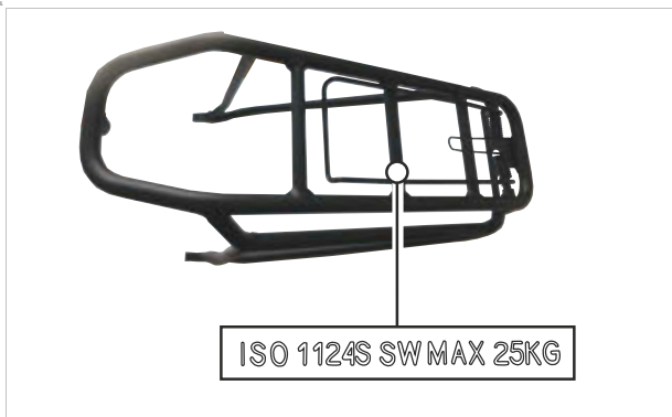
105. ábra: A csomagtartón fel van tüntetve a maximális teherbírása
