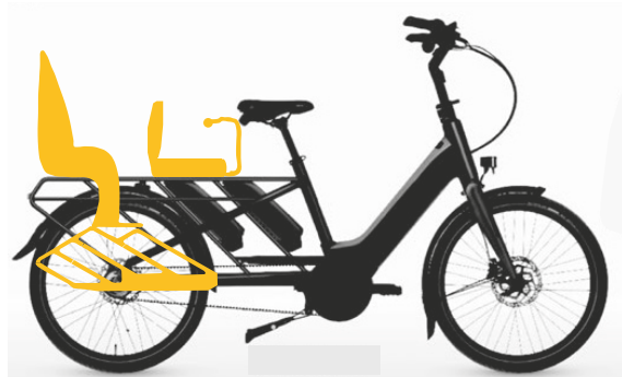
97. ábra: Egy gyerekülés hátul és egy ülőpárna lábtámasszal (sideblade) előtt, 1 fiatal (1-6 éves, 9-22 kg súlyú) és egy idősebb (6-10 éves, 18-38 kg súlyú) gyermek számára megfelelő
