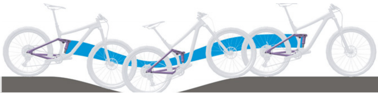
Rysunek 237: Zbyt miękkie amortyzowanie tylnego amortyzatora na wzniesieniu
