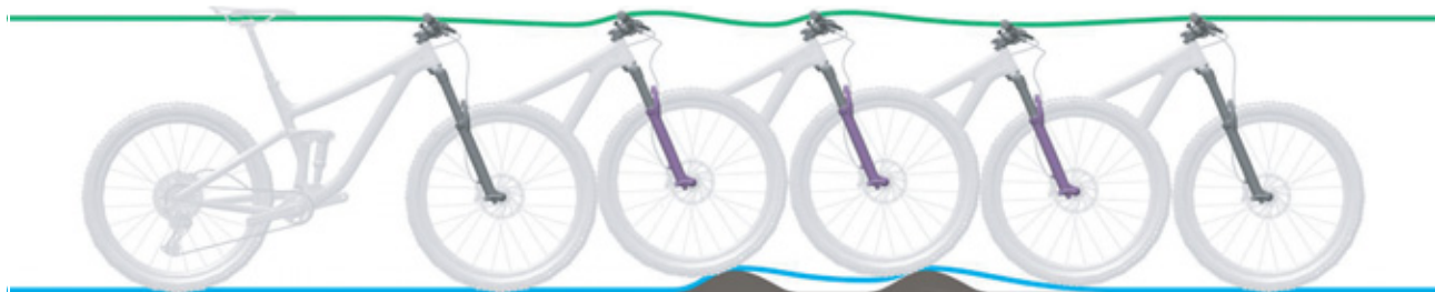
Rysunek 217: Zbyt wolne rozprężanie widelca amortyzowanego
