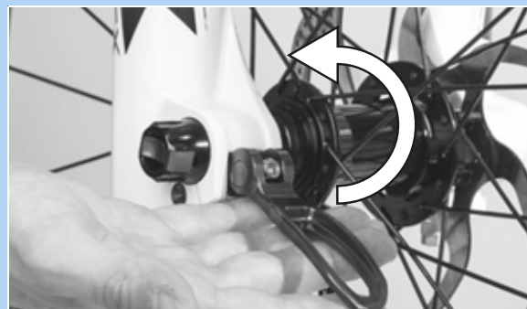
Rysunek 68: Docisnąć dźwignia zacisku szybkomocującego zgodnie z kierunkiem strzałki
