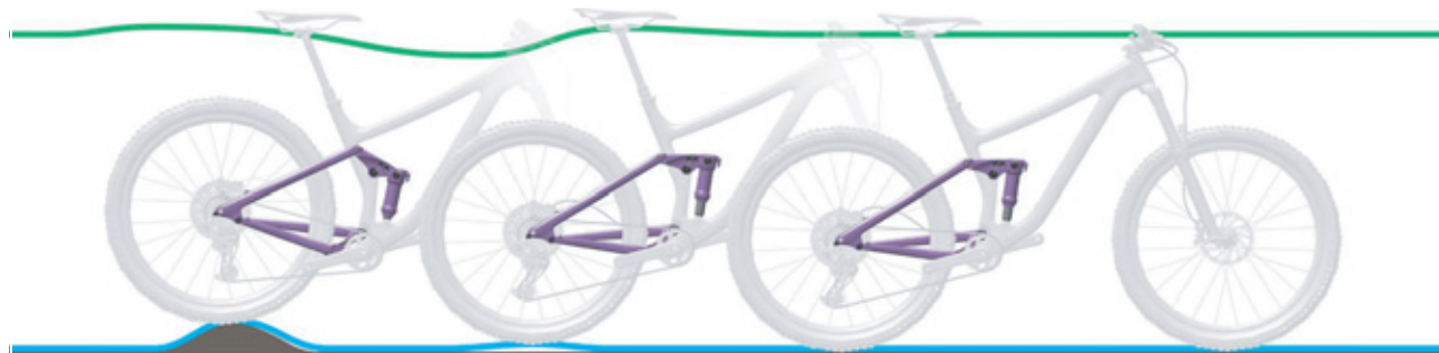
Rysunek 241: Zbyt szybkie rozprężanie się tylnego amortyzatora
