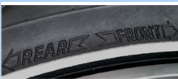
Rysunek 60: Strzałka kierunku obrotów na oponach MTB
