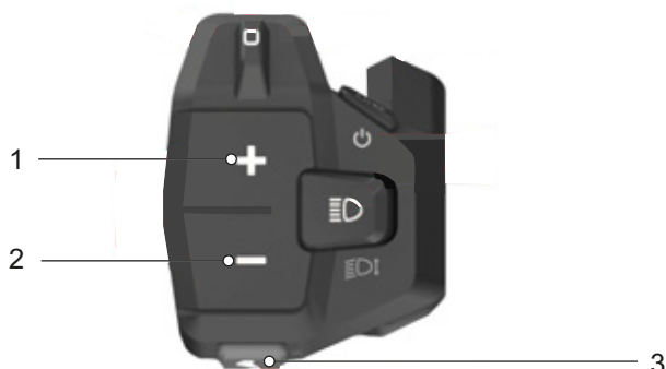
Rysunek 150: Położenie przycisków Plus (1), Minus (2), i mechanizmu wspomagającego pchanie (3)
