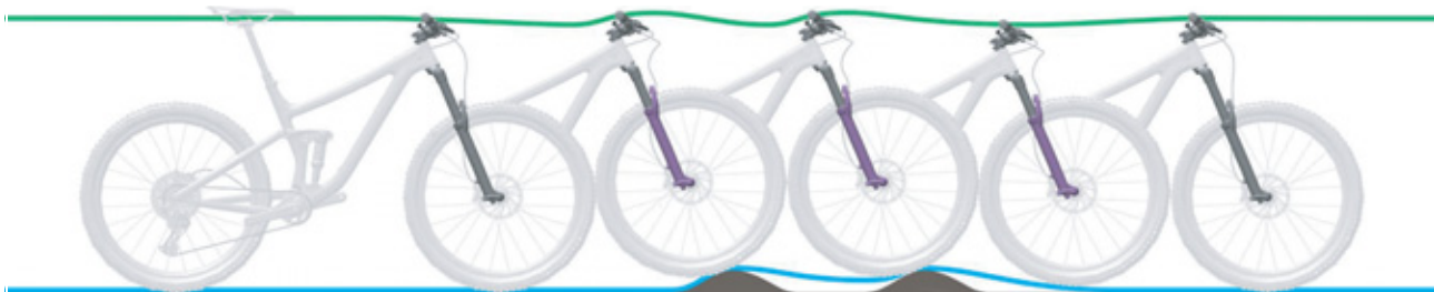
Rysunek 209: Zbyt wolne rozprężanie widelca amortyzowanego
