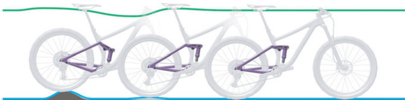
Rysunek 225: Zbyt szybkie rozprężanie się tylnego amortyzatora
