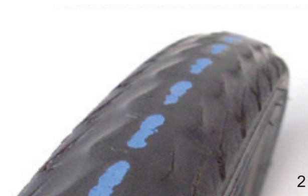
Rysunek 165: Opona bez bieżnika, którą można wymienić (1) i opona z prześwitującą ochroną przed przebicciem (2), którą należy wymienić
