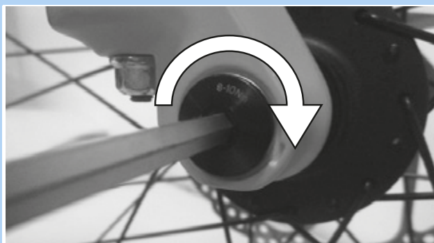
Rysunek 62: Dokręcić oś zgodnie z kierunkiem strzałki.
