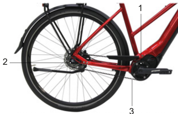
Rysunek 32: Schemat napędu paskowego
