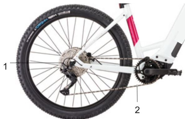
Rysunek 31: Schemat napędu łańcuchowego z przerzutką
