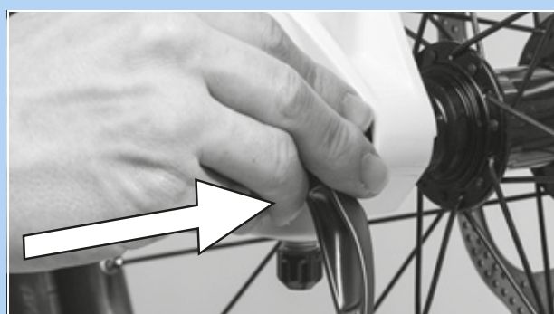
Rysunek 72: Wcisnąć zacisk szybko mocujący zgodnie z kierunkiem strzałki
