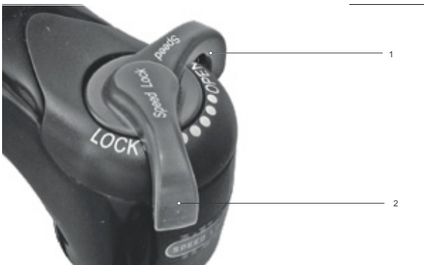
Rysunek 204: Ustawienie nastawnika dobiecia na twardszy tryb pracy
