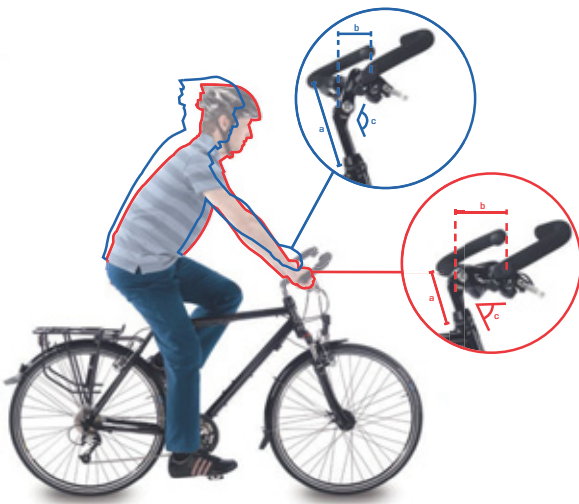
Rysunek 110: Pozycja roweru miejskiego (niebieski) i trekkingowego (czerwony) dzięki regulacji kąta nachylenia
