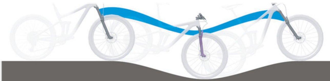
Rysunek 219: Zbyt miękkie amortyzowanie widełca na wzniesieniu
