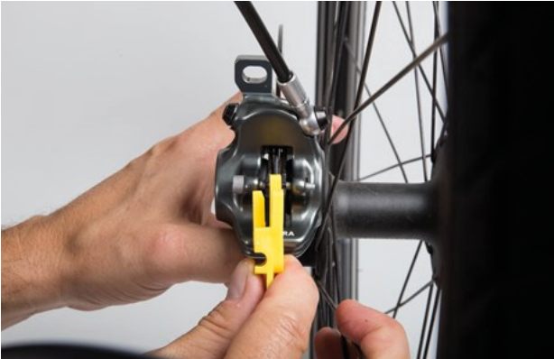
Rysunek 167: Sprawdzenie stanu klocków hamulca w stanie zamontowanym za pomocą zabezpieczenia transportowego
