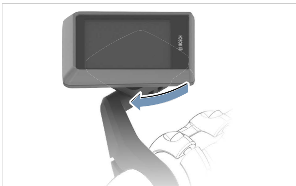
135. ábra: A kijelző elforgatása az óramutató járásával egyező irányban
