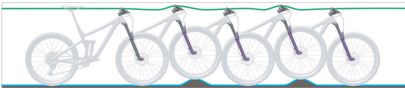
15. ábra: A teleszkópos villa optimális menetviselkedése
