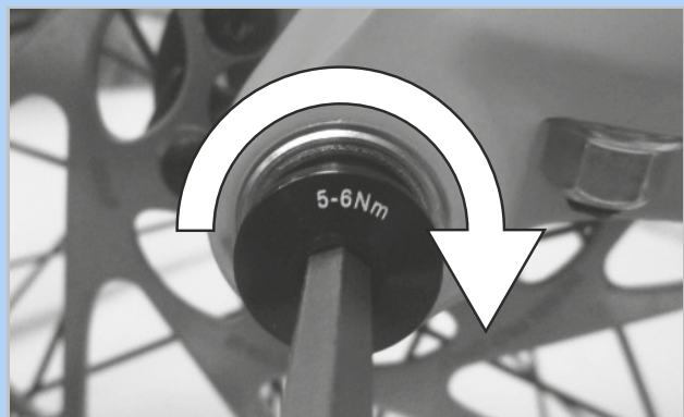
72. ábra: A rögzítőcsavar meghúzása
