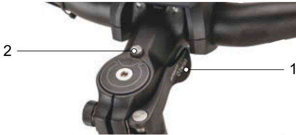
170. ábra: II kivitelű kormányoszár a kormányoszár-gyorszár (1) gyorskioldójával és reteszoldó gombbal (2)
