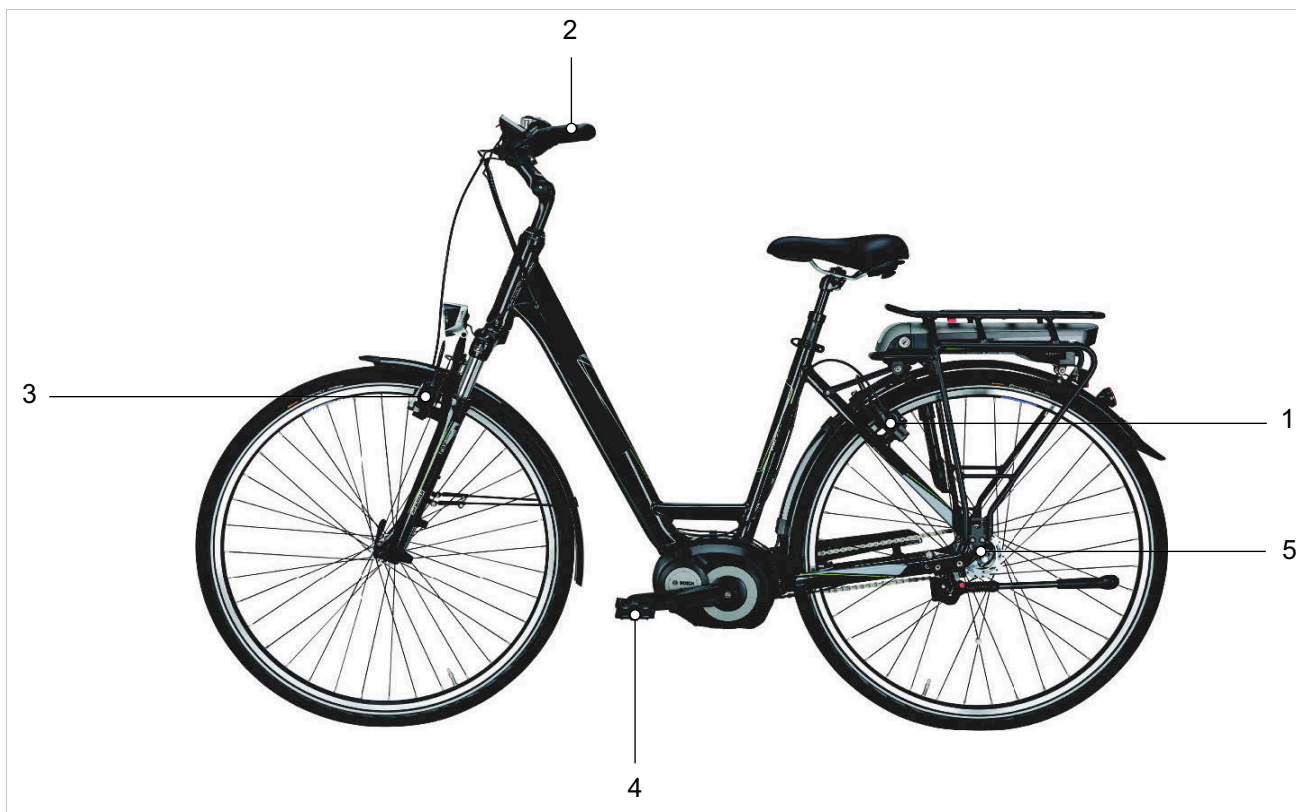
35. ábra: Fékrendszer kontrafékkel, példa
