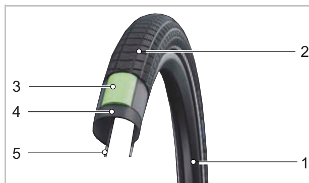
26. ábra: Nyitott gumiabroncsok felépítése
