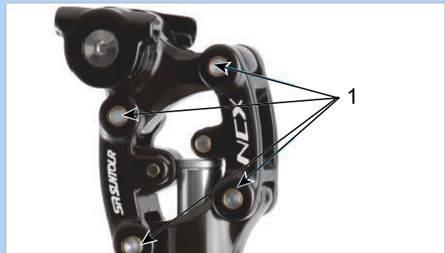
202. ábra: SR SUNTOUR rugós nyeregcső kenőpontjai
