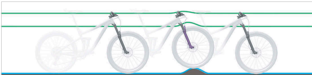
17. ábra: A teleszkópos villa optimális menetviselkedése egyenetlenségek esetén
