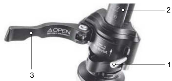
169. ábra: A kormányszár-gyorszár (3) nyitott gyorskioldója a kormányszáron (2), I kivitel, a kormányszáron (1) lévő rögzítőkarral
