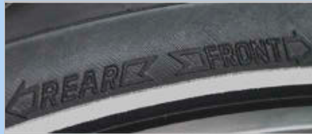
68. ábra: Futásirányjelző nyíl MTB gumiabroncsokon
