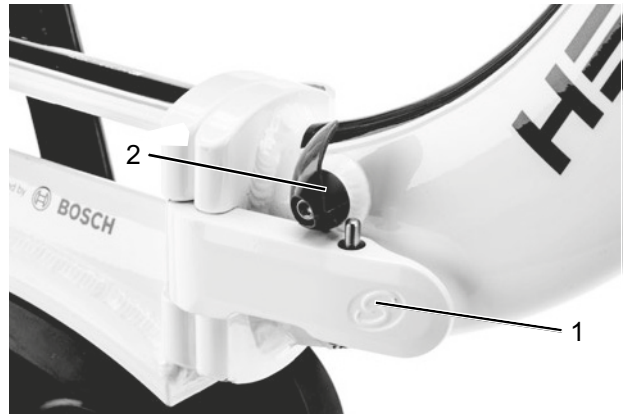
171. ábra: Zárt (1) és nyitott (2) váz-rögzítőkarnál
