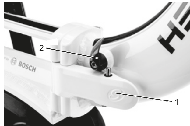
Figura 43: Palanca de seguridad del cuadro cerrada (1) y abierta (2)
