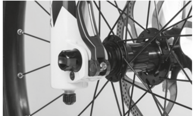
Figura 48: Ajuste de la fuerza de tensado del cierre rápido
