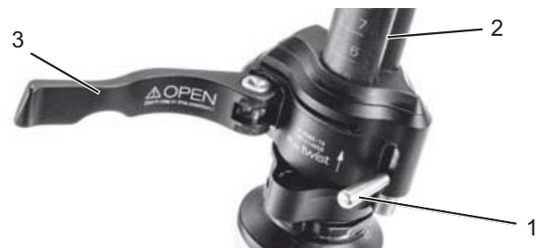
Figura 41: Palanca tensora abierta del cierre rápido de la potencia (3) en la potencia (2), versión I, con palanca de seguridad en la potencia (1)
