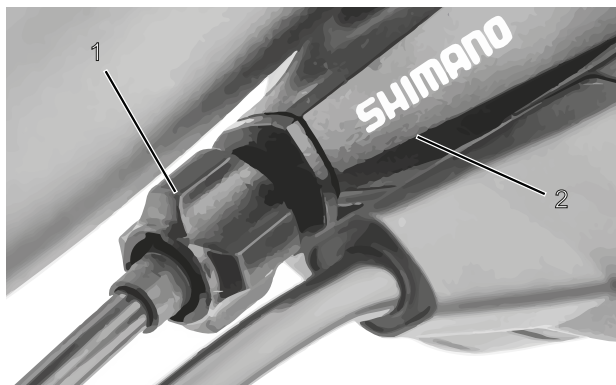
Figura 50: Casquillo de ajuste (1) del cambio de marchas accionado por cable de accionamiento con carcasa de la palanca de cambio (2), ejemplo
