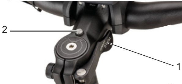
Figura 42: Potencia, versión II con palanca tensora del cierre rápido de la potencia (1) y botón de desbloqueo (2)
