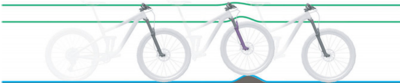
Obr. 7: Optimální chování vidlice při jízdě u nerovností
