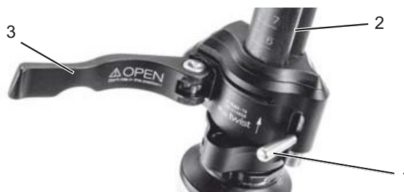
Obr. 41: Otevřená upínací páka rychloupínáku (3) představce (2) v provedení I s pojistnou pákou na představci (1)
