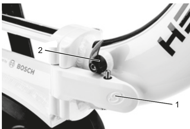
Obr. 43: Zavřená (1) a otevřená (2) pojistná páka rámu
