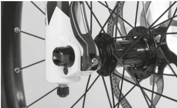
Obr. 48: Nastavení upínací síly rychloupínáku
