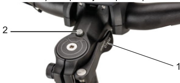
Obr. 42: Představec, provedení II s upínací pákou rychloupínáku představce (1) a odblokovacím knoflíkem (2)
