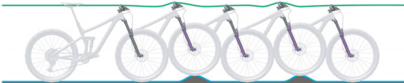
Obr. 5: Optimální chování vidlice při jízdě
