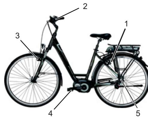
Figur 12: Bremsesystem på en elcykel med frihjulsbremse, eksempel
