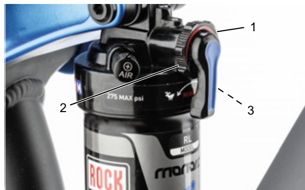
Figur 90: Indstilling af trækdæmperens hårdhed på bagdæmperens indstillingshjul (1)
