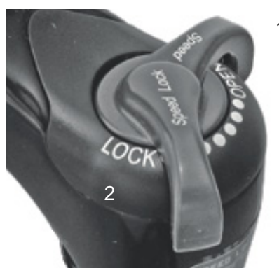
Figur 87: Suntour-trykindsstillingsanordning med positionerne OPEN (1) og LOCK (2)
