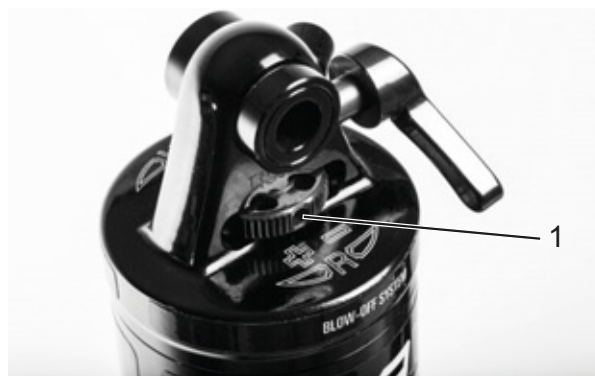
Figur 64: Hjul (1) for Suntour-træktrinsindstillingsanordning på bagdæmperen
