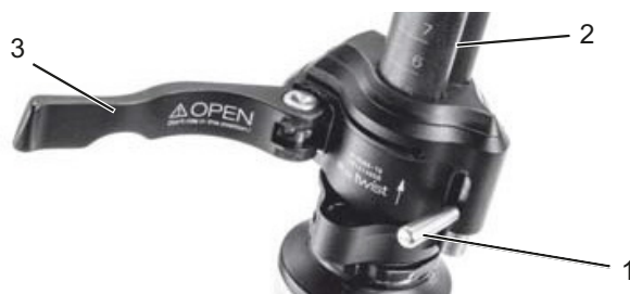
Figur 71: Åbnet greb på hurtigbespændingen (3) på frempinden (2), udførelse I, med låsegreb på frempinden (1)
