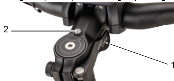
Figur 72: Frempind, udførelse II med greb på frempindens hurtigbespænding (1) og frigørelsesknop (2)
