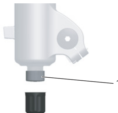
Figur 63: FOX-træktrins-indstillingsanordning (1) på gavlens
