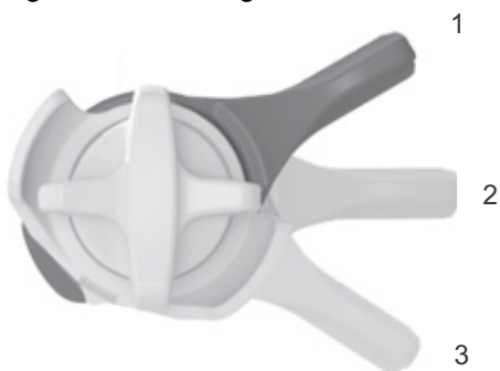
Figur 85: FOX-trykindsstillingsanordning på bagdæmper med positionerne ÅBEN (1), MELLEEM (2) og HÅRD (3)
