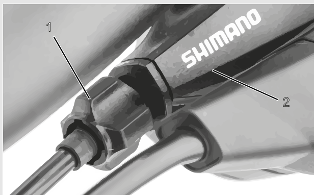
Figur 97: Slutmuffe (1) på gearskiftet med ét kabel og gearvælgerhus (2), eksempel
