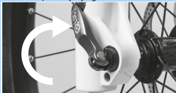
Rysunek 75: Zamykanie zacisku szybko mocującego
