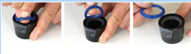
Rysunek 204: Wyciąganie zgarniacza
