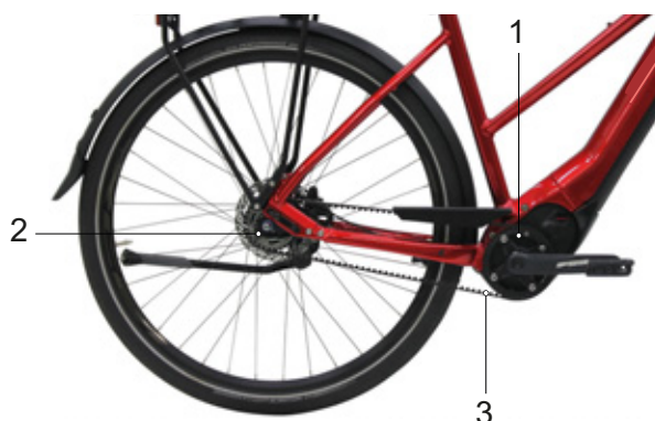
Rysunek 27: Schemat napędu paskowego
