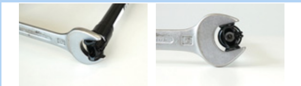
Rysunek 180: Zabezpieczenie przed przekręceniem się
