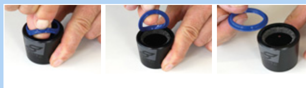
Rysunek 169: Wyciąganie zgarniacza
