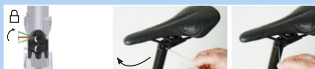
Rysunek 196: Zamykanie mechanizmu regulacji wysokości
