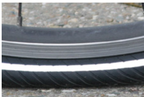
Rysunek 98: Zbyt niskie ciśnienie w oponie
