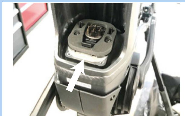
Rysunek 51: Zamontowane płytki adaptacyjne
