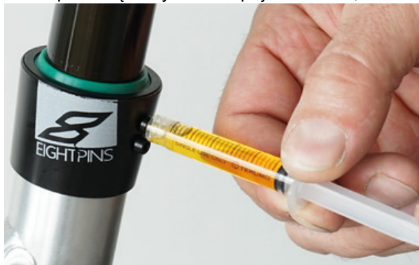
Rysunek 144: Smarowanie rury sztycy podsiodłowej
