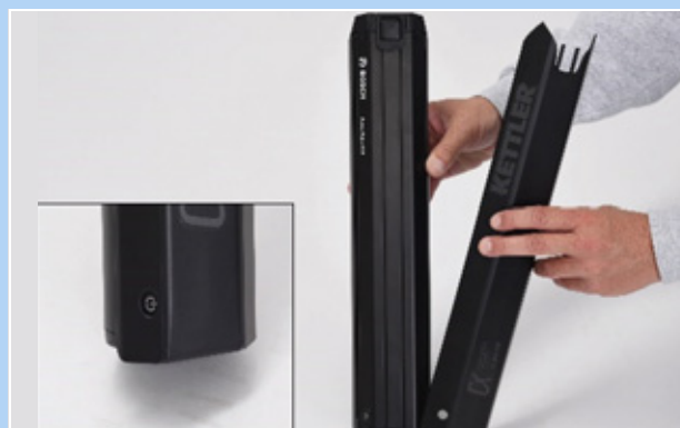
Rysunek 55: Wsuwanie pokrywy na akumulator
