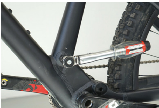
Rysunek 81: Dociąganie osi sztycy podsiodłowej
