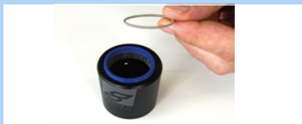
Rysunek 168: Wyciągnięty pierścień sprężysty
