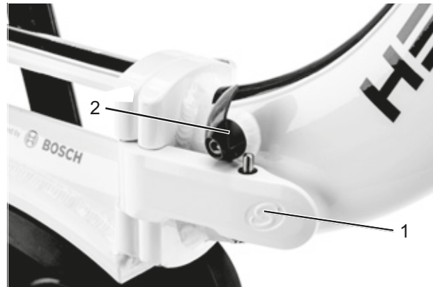
Rysunek 135: Otwarta (1) i zamknięta (2) dźwignia zabezpieczająca ramy
