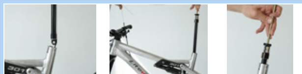
Rysunek 187: Mocowanie nakrętki zaworu wkładu
