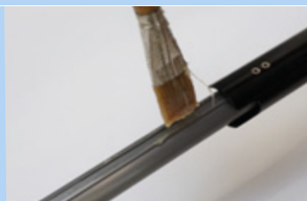
Rysunek 213: Nakładanie smaru
