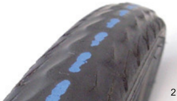
Rysunek 146: Opona bez bieżnika, która jeszcze nadaje się do jazdy (1) i opona z prześwitującą ochroną przed przebiciem (2), którą należy wymienić
