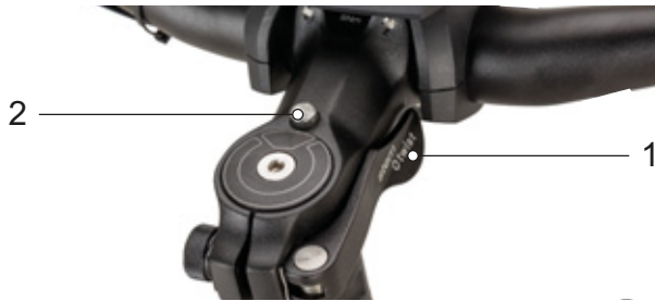
Rysunek 134: Mostek, wersja II z dźwignią mocującą zacisku szybko mocującego (1) mostka i przyciskiem odblokowującym (2)
