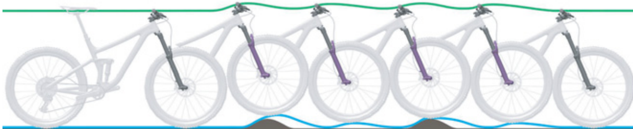
Rysunek 221: Zbyt szybkie rozprężanie widelca amortyzowanego
