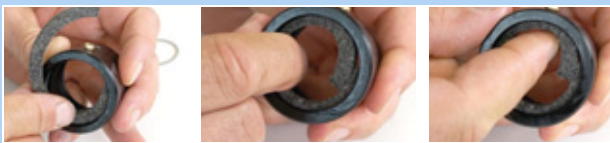
Rysunek 207: Wkładanie pierścienia filcowego
