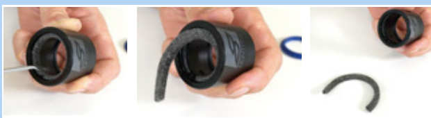
Rysunek 205: Wyciąganie pierścienia filcowego
