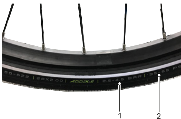
Rysunek 145: Ciśnienie w oponach w barach (1) i psi (2)
