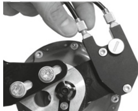
Rysunek 152: Wersje piast Rohloff z zewnętrznym sterowaniem zmiany biegów mają regulator linki na przepustnicy kablowej, która znajduje się po lewej stronie
