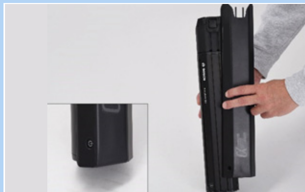
Rysunek 59: Wsuwanie pokrywy na akumulator
