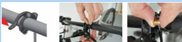
Rysunek 161: Demontaż wkładu
