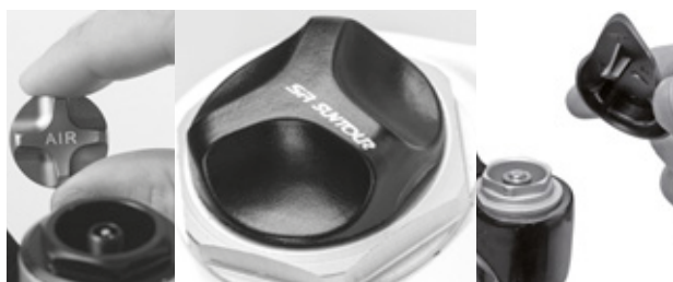
Rysunek 106: Oslony gwintowane dostępne w różnych wersjach
