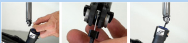
Rysunek 217: Zaczepianie i wsuwanie sztycy podsiodłowej
