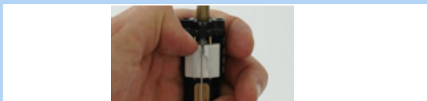
Rysunek 185: Przesuwanie białego przełącznika w dół
