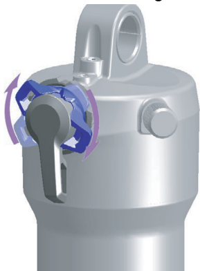
Abbildung 109: Druckstufeneinsteller härter einstellen
