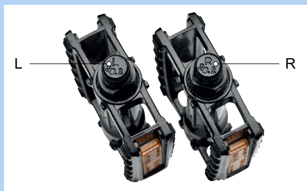
Abbildung 65: Beispiel Kennzeichnung von Pedalen
