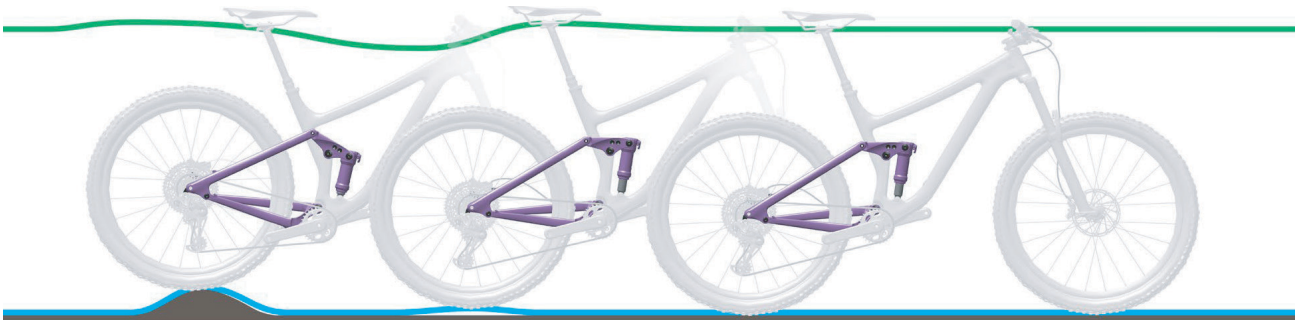
Abbildung 222: Zu schnelles Ausfedern des Hinterbau-Dämpfers
