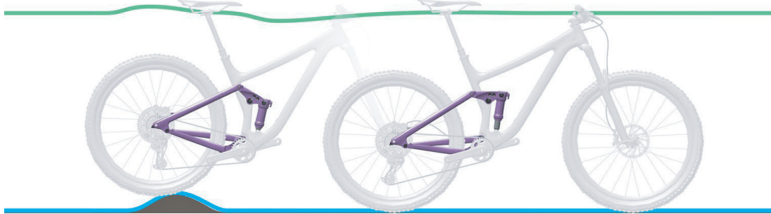
Abbildung 17: Optimales Fahrverhalten des Hinterbau-Dämpfers bei Unebenheiten
