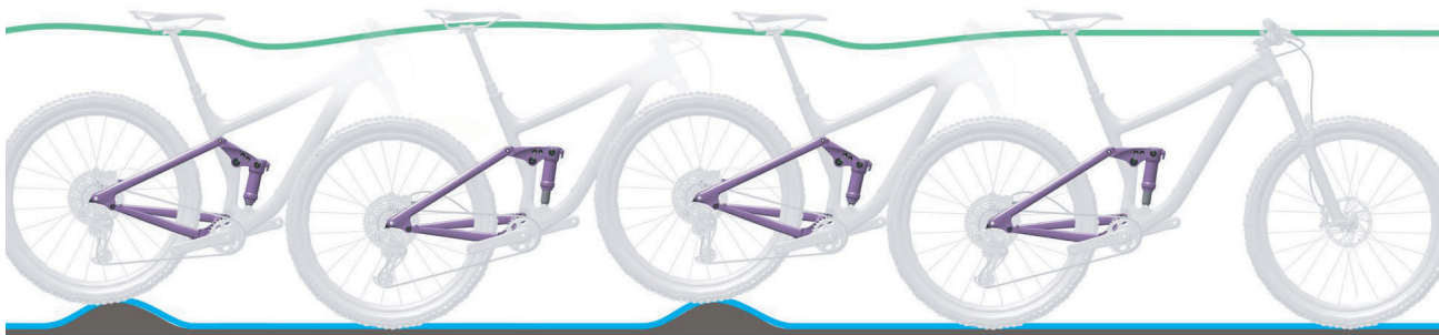
Abbildung 104: Optimales Fahrverhalten des Hinterbau-Dämpfers
