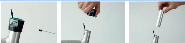
Abbildung 160: Außenhülse und Gleitbuchse ausbauen
