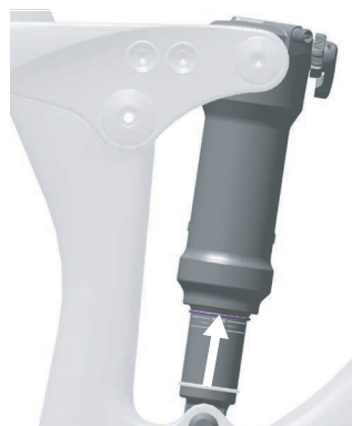
Abbildung 101: O-Ring am Hinterbau-Dämpfer verschieben
