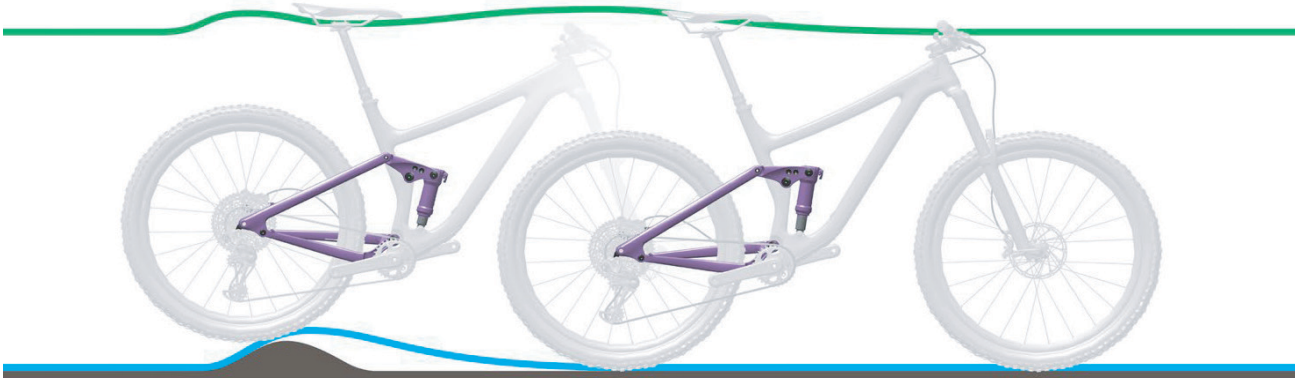
Abbildung 228: Zu harte Dämpfung des Hinterbau-Dämpfers bei Unebenheiten
