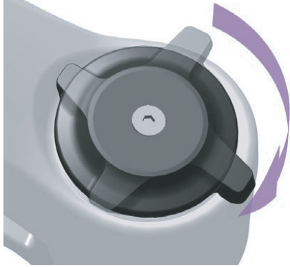
Abbildung 129: Druckstufeneinsteller härter einstellen
