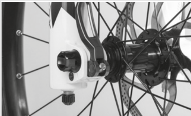
Afbeelding 88: Spankracht van de snelspanner afstellen
