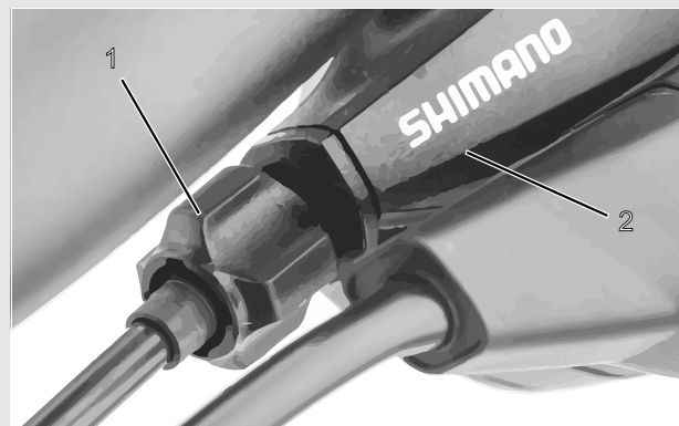
Afbeelding 90: Afstelwartel (1) van de versnelling met enkele bowdenkabelbediening en behuizing van de schakelhendel (2), voorbeeld
