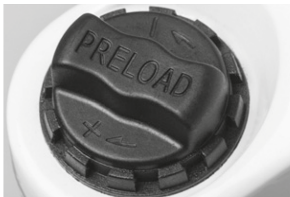
Afbeelding 64: Afstelwiel voor de negatieve veerweg op de kroon van de verende voorvork
