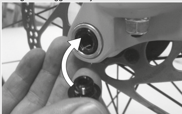
Afbeelding 34: Snelspanhendel in as schuiven
