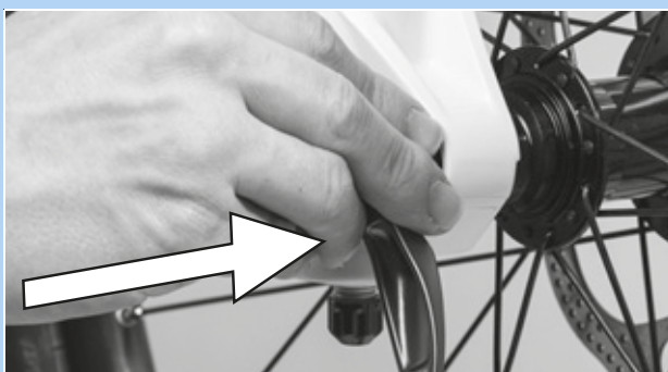
Illustration 64 : Enfoncez l'attache rapide dans le sens de la flèche
