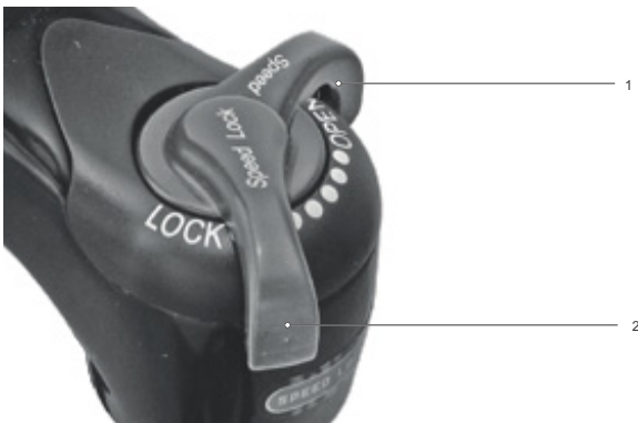
Illustration 229 : Régler le dispositif de réglage de la compression sur un niveau plus dur
