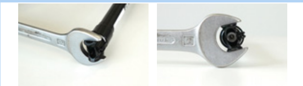
Illustration 183 : Empêcher l'interface de montage de tourner
