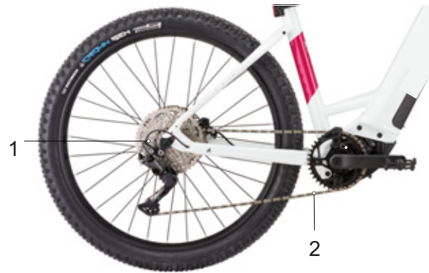
Illustration 26 : Schéma de l'entraînement à chaîne avec dérailleur
