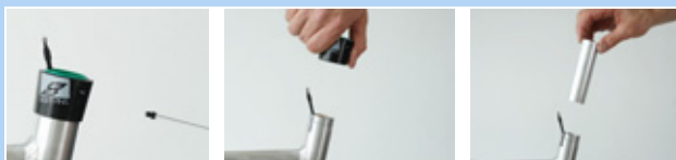
Illustration 170 : Démontez l'enveloppe extérieure et la douille de glissement
