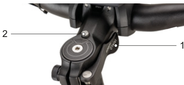
Illustration 140 : Potence, modèle II avec levier de serrage de l'attache rapide de la potence (1) et bouton de déblocage (2)
