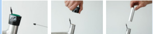
Illustration 204 : Démonter l'enveloppe extérieure et la douille de glissement
