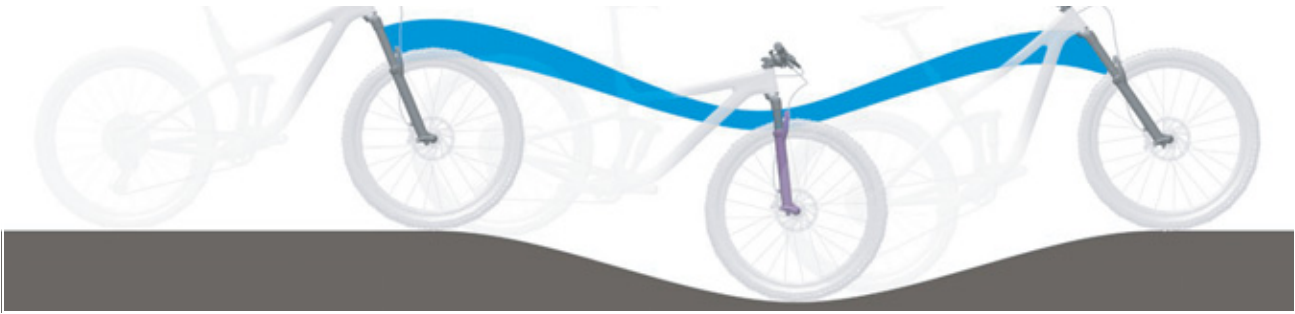
Illustration 228 : Suspension trop souple de la fourche suspendue dans les côtes
