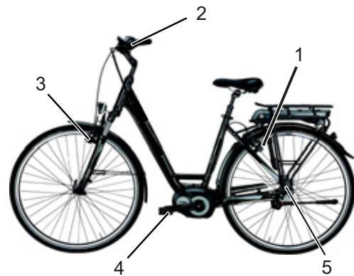
Figura 12: Sistema de frenado de un Pedelec con un freno de contrapedal, ejemplo
