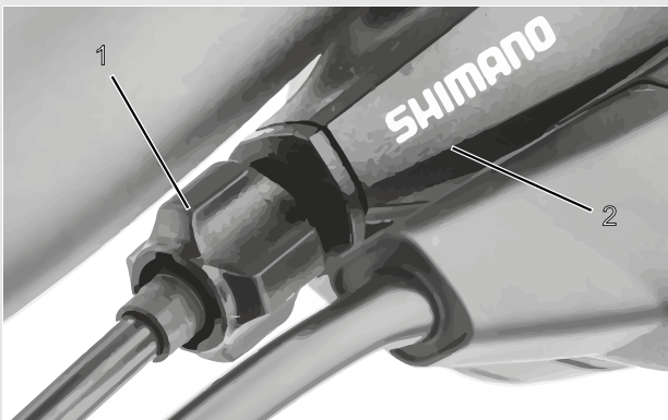
Figura 85: Casquillo de ajuste (1) del cambio de marchas accionado por cable de accionamiento con carcasa de la palanca de cambio (2), ejemplo
