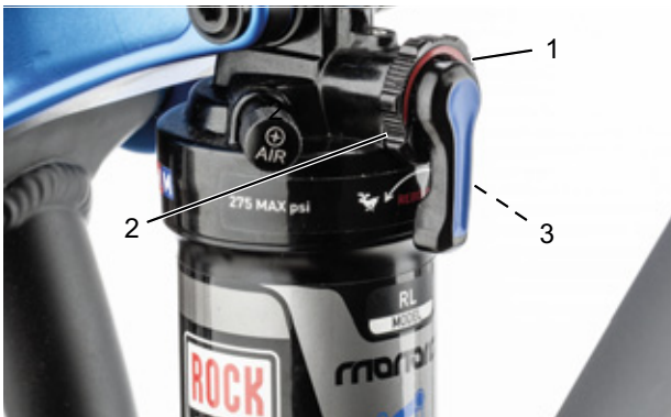
Figura 78: Ajuste de la dureza del amortiguador de niveles de tracción en la rueda de ajuste (1) del amortiguador de la horquilla trasera
