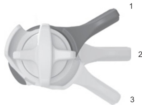
Figura 73: Regulador de niveles de presión FOX en el amortiguador de la horquilla trasera con las posiciones ABIERTO (1), MEDIO (2) y DURO (3)
