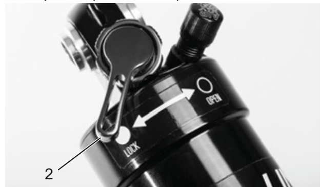
Figura 77: Regulador de niveles de presión Suntour cerrado (2)
