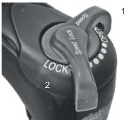
Figura 75: Regulador de niveles de presión Suntour con las posiciones OPEN (1) y LOCK (2)
