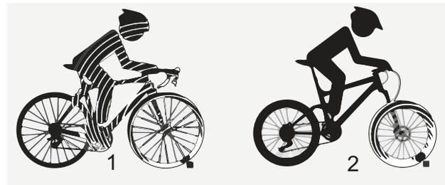
Figura 4: Pedelec sin suspensión (1) y con suspensión (2)
