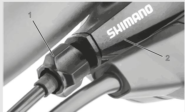
Figura 66: Casquillo de ajuste (1) del cambio de marchas accionado por cable de accionamiento con carcasa de la palanca de cambio (2), ejemplo
