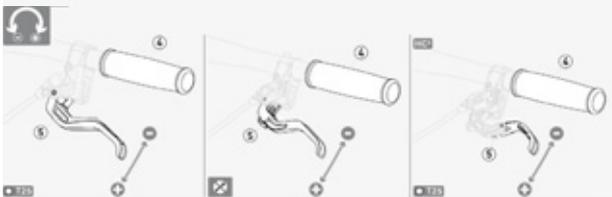
Figura 36: Ajustar el ancho de agarre de la palanca de freno con freno de disco Magura
