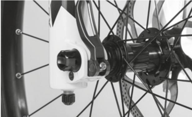
Figura 64: Ajuste de la fuerza de tensado del cierre rápido
