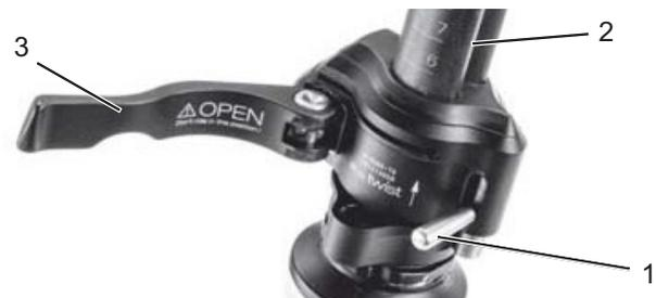
Figura 57: Palanca tensora abierta del cierre rápido de la potencia (3) en la potencia (2), versión I, con palanca de seguridad en la potencia (1)
