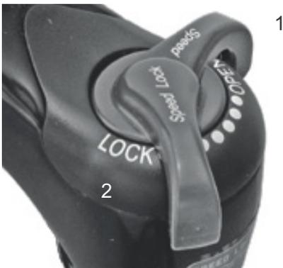
Figura 52: Regulador de niveles de presión Suntour con las posiciones OPEN (1) y LOCK (2)
