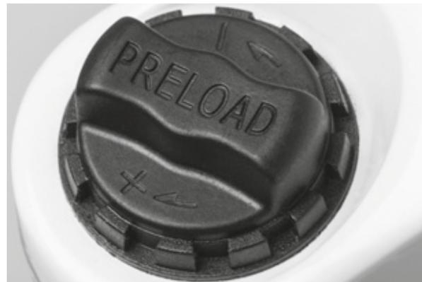
Figura 38: Rueda de ajuste del recorrido negativo de muelle en la corona de la horquilla de suspensión
