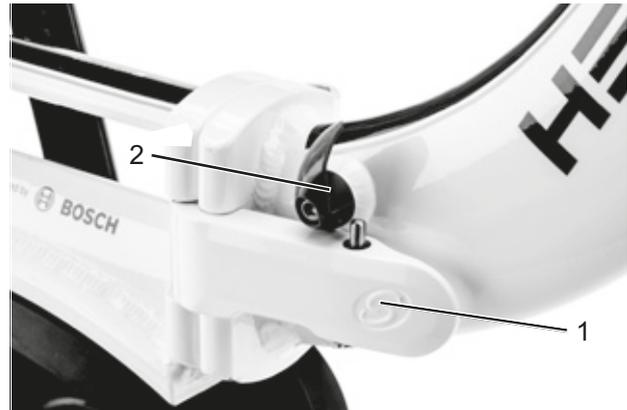
Figura 59: Palanca de seguridad del cuadro cerrada (1) y abierta (2)
