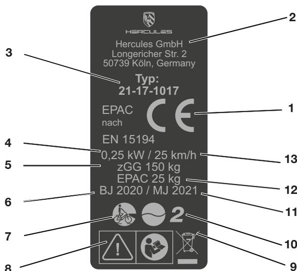
Figura 1: Ejemplo Placa indicadora de tipo
