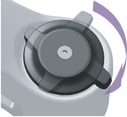
Abbildung 129: Druckstufeneinsteller härter einstellen
