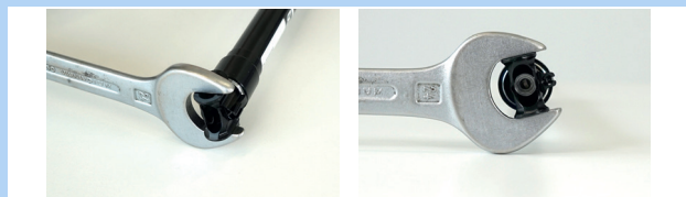
Abbildung 173: Gegen Verdrehen sichern
