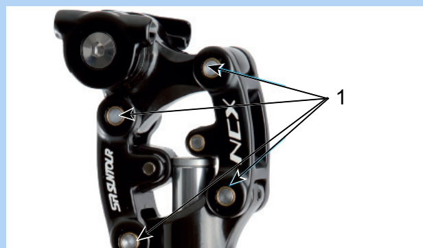
Abbildung 151: Schmierpunkte SR Suntour Feder-Sattelstütze
