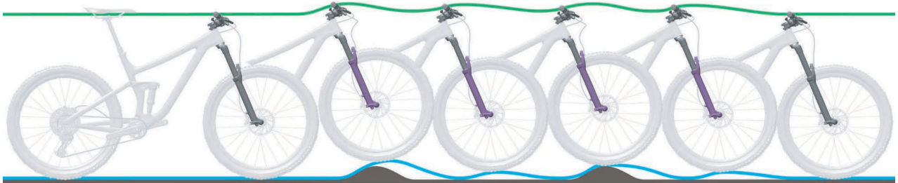
Abbildung 229: Zu schnelles Ausfedern der Federgabel
