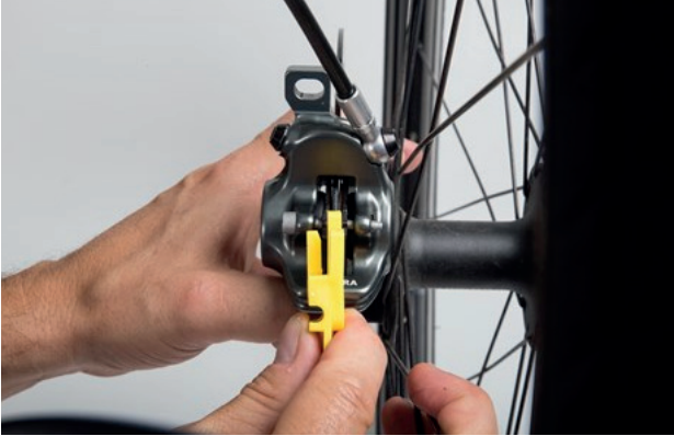
Abbildung 142: Bremsbelag im eingebauten Zustand mithilfe der Transportsicherung prüfen
