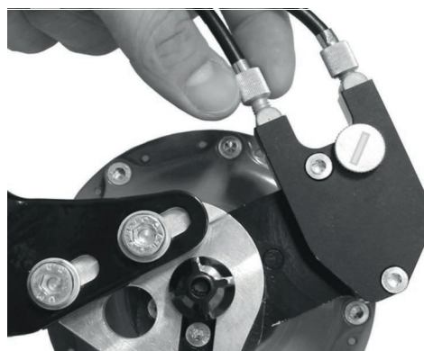
Abbildung 146: ROHLOFF-Naben Versionen mit externer Schaltungsteuerung haben die Zugeinsteller an der Seilbox, die sich auf der linken Seite befindet
