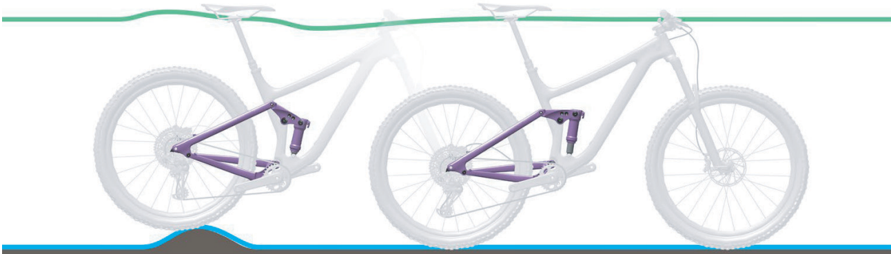
Abbildung 106: Optimales Fahrverhalten des Hinterbau-Dämpfers bei Unebenheiten
