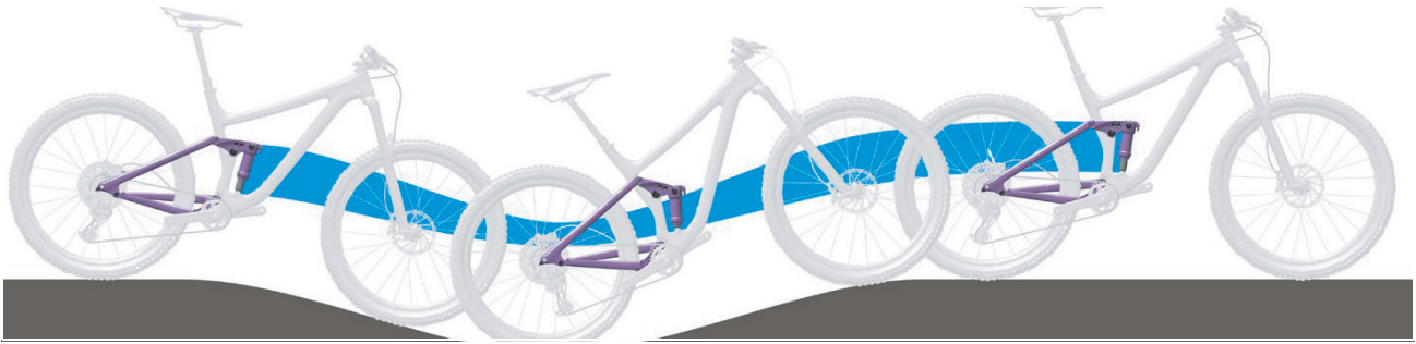
Abbildung 262: Zu weiche Federung des Hintebau-Dämpfers am Berg
