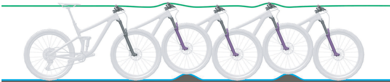
Abbildung 102: Optimales Fahrverhalten der Gabel
