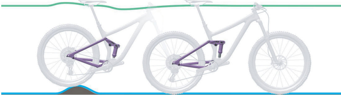
Abbildung 17: Optimales Fahrverhalten des Hinterbau-Dämpfers bei Unebenheiten
