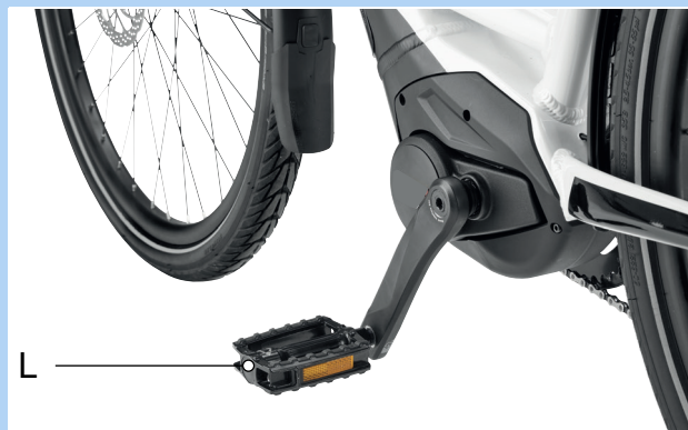
Abbildung 66: L-Pedal im linken Kurbelarm
