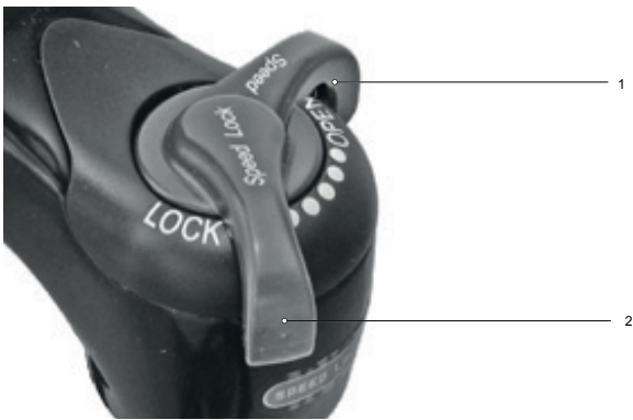
Abbildung 219: Druckstufeneinsteller härter einstellen
