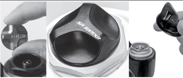
Abbildung 99: Schraubabdeckungen in unterschiedlichen Ausführungen
