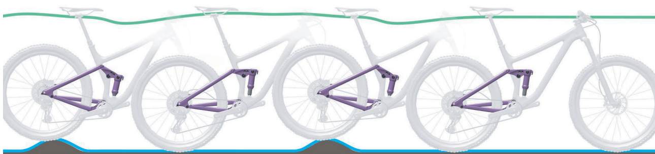
Abbildung 104: Optimales Fahrverhalten des Hinterbau-Dämpfers
