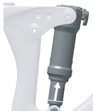
Abbildung 101: O-Ring am Hinterbau-Dämpfer verschieben
