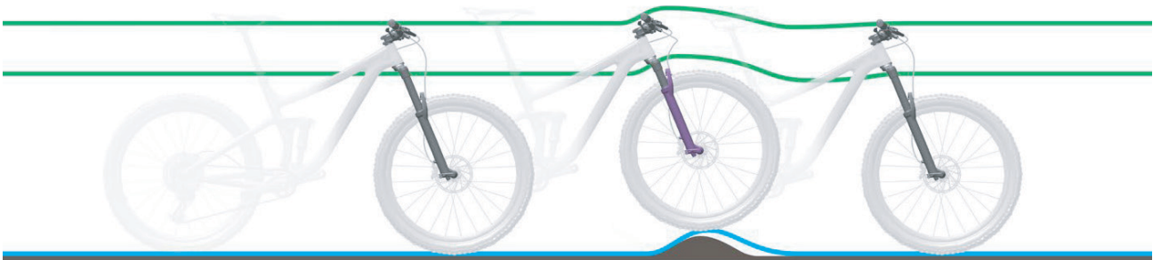
Abbildung 220: Zu harte Dämpfung der Federgabel bei Unebenheiten
