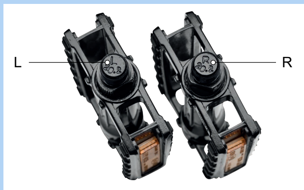
Abbildung 65: Beispiel Kennzeichnung von Pedalen
