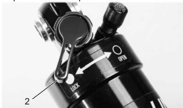
Figura 78: Regolatore della compressione Suntour chiuso (2)
