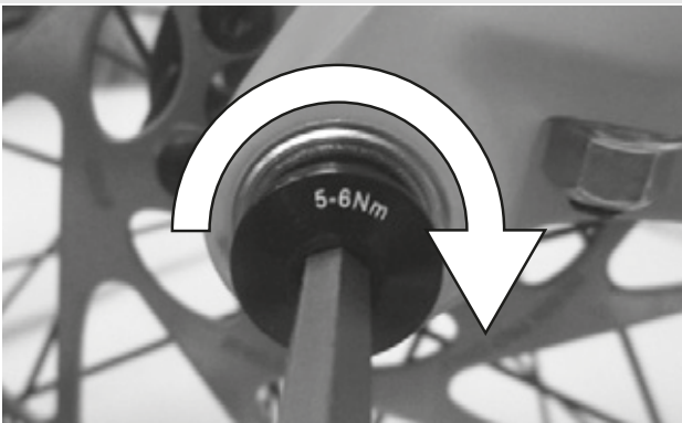
Figura 28: Serraggio della vite di sicurezza
