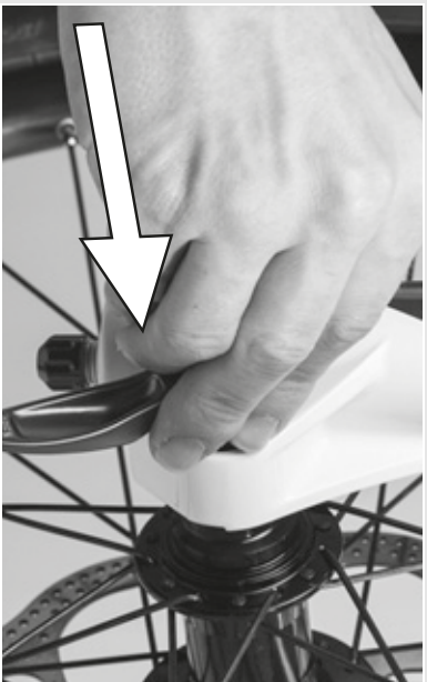
Figura 38: Inseririmento del bloccaggio rapido
