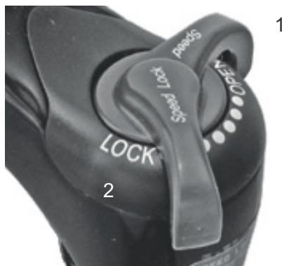
Figura 76: Regolatore della compressione Suntour con posizioni OPEN (1) e LOCK (2)
