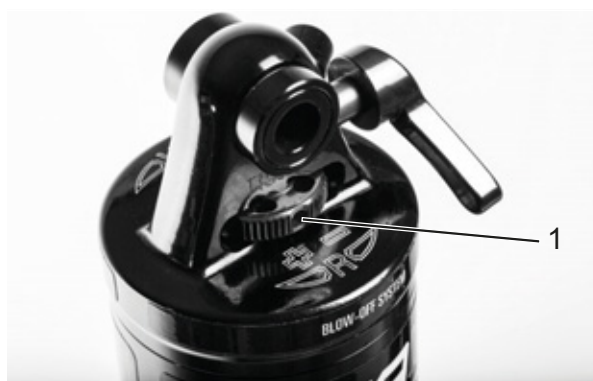
Figura 61: Regolatore del rebound Suntour (1) sull'ammortizzatore del carro posteriore
