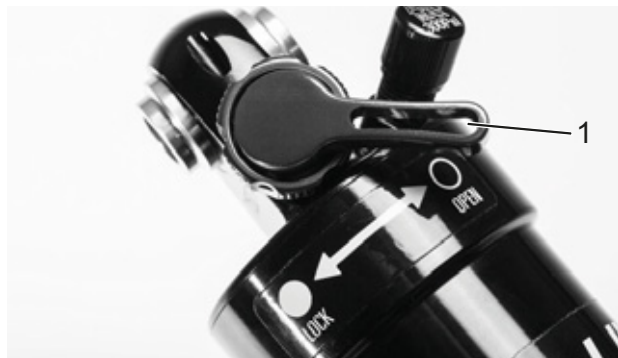
Figura 77: Regolatore della compressione Suntour aperto (1)
