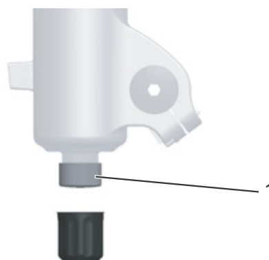
Figura 60: Regolatore del rebound FOX (1) sulla forcella
