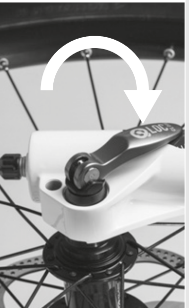
Figura 40: Chiusura del bloccaggio rapido
