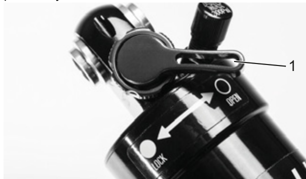
Rysunek 66: Nastawnik dobicia Suntour w pozycji otwartej (1)
