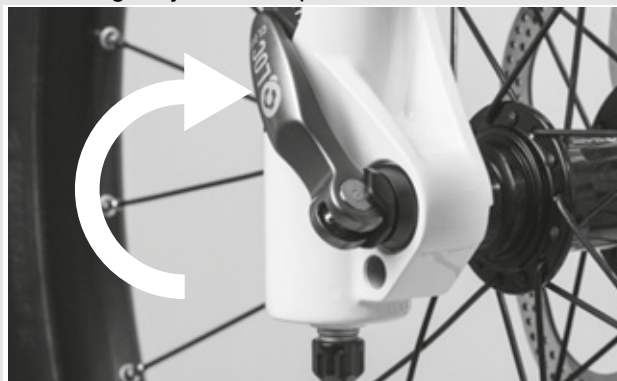
Rysunek 35: Zamykanie zacisku szybko mocującego
