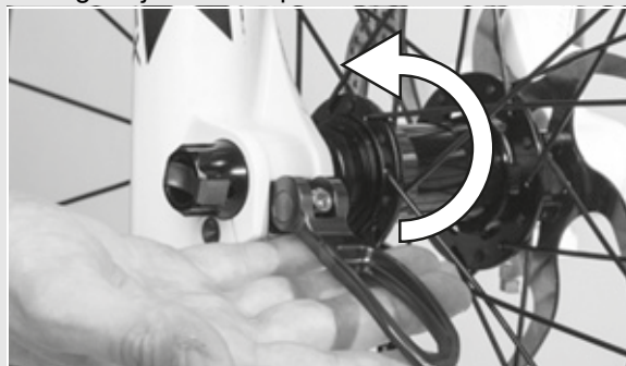
Rysunek 29: Sposób zabezpieczania dźwigni
