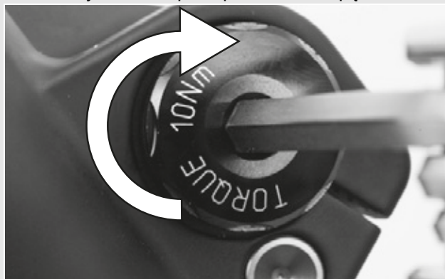
Rysunek 24: Sposób dokręcania włożonej osi
