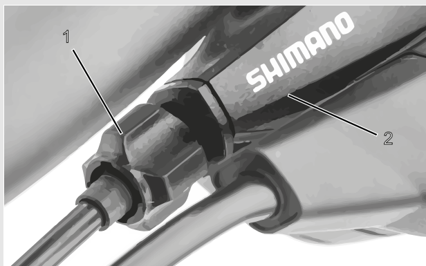
Rysunek 75: Nakrętka regulacyjna (1) jednoczęściowego mechanizmu zmiany przerzutek z obudową dźwigni zmiany biegów (2), przykład
