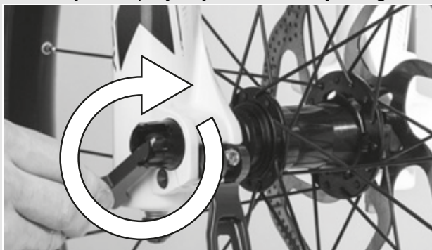
Rysunek 27: Sposób dokręcania osi
