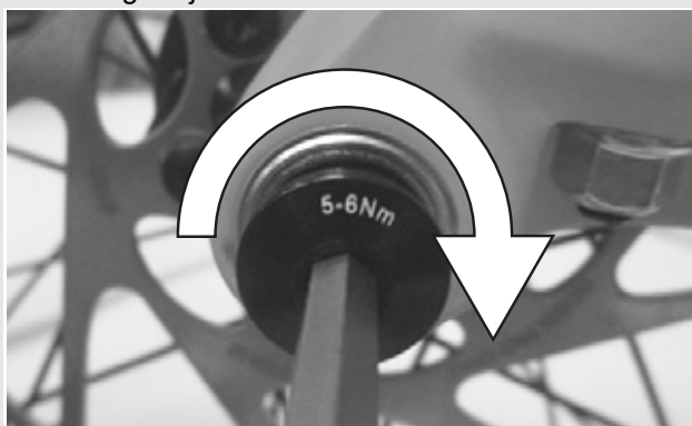
Rysunek 23: Sposób dokręcania śruby zabezpieczającej
