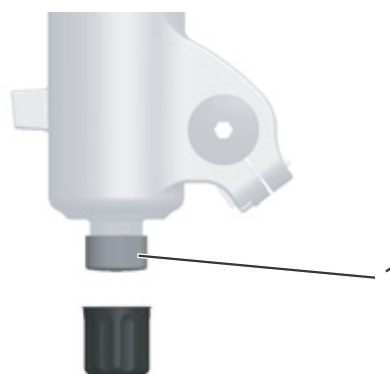
Rysunek 55: Nastawnik odbicia (1) FOX na widelcu
