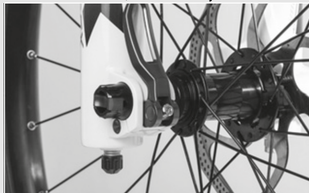
Rysunek 30: Optymalne położenie dźwigni mocującej
