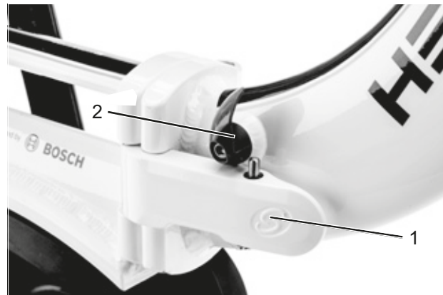
148 paveikslėlis. Uždaryta (1) ir atidaryta (2) rėmo saugos svirtis
