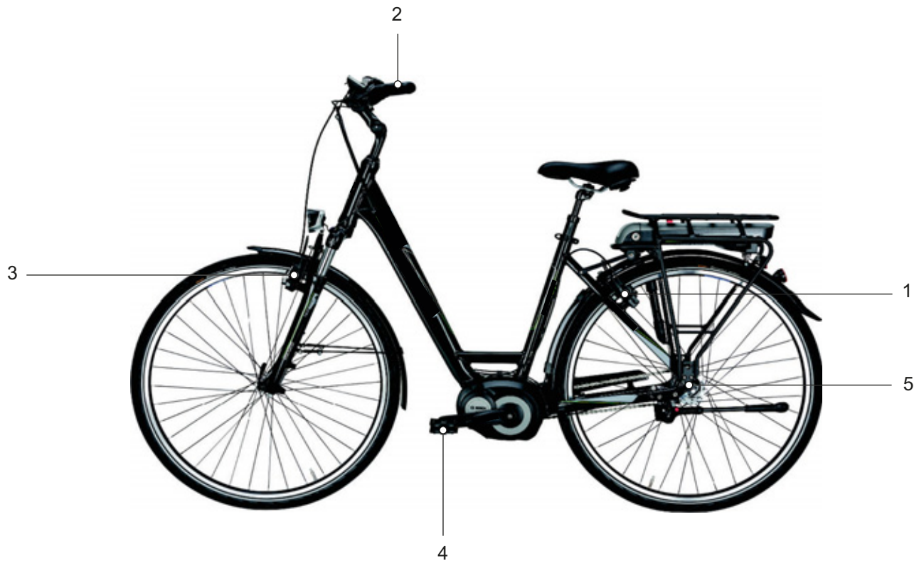
22 paveikslėlis. Stabdžių sistema su kojineis pedalineis stabdžiais, pavyzdys
