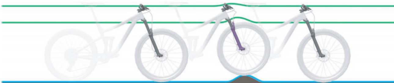
7 paveikslėlis. Optimali šakių važiavimo charakteristika nelygumuose
