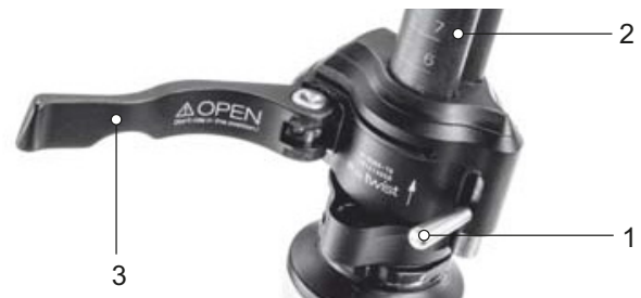
146 paveikslėlis. Atidarykite greitojo atpalaidavimo svirtį (3) ant vairo iškyšos (2), I versija, su tvirtinimo svirtimi ant vairo iškyšos (1)
