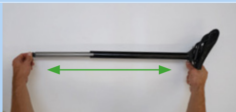
221 paveikslėlis. Ištraukite balnelio stovą
