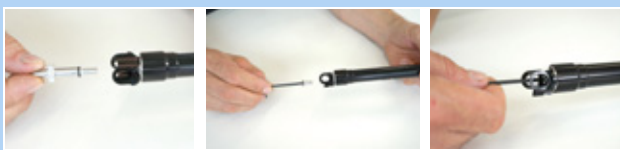
188 paveikslėlis. Pritvirtinkite kasetės vožtuvo dangtelį
