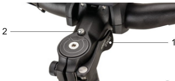
147 paveikslėlis. Vairo iškyša, II versija su stiebo greitojo atleidimo (1) ir atleidimo mygtuko (2) įtempimo svirtimi
