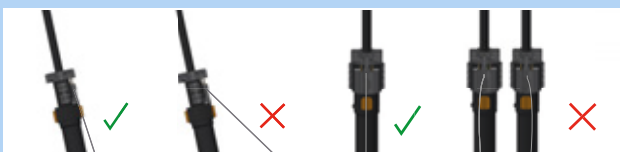
196 paveikslėlis. Teisingas ir neteisingas Bowdeno trosu traukimas
