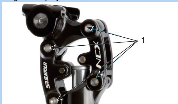
168 paveikslėlis. Spyruoklinio balnelio stovo „SR Suntour“ sutepimas
