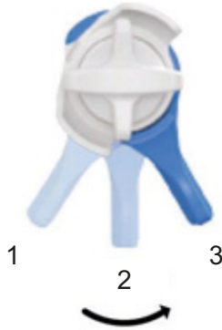
126. ábra: A 3-utas kar beállítása zárt (1) helyzetből középhezleten (2) át nyitva (3) helyzetig
