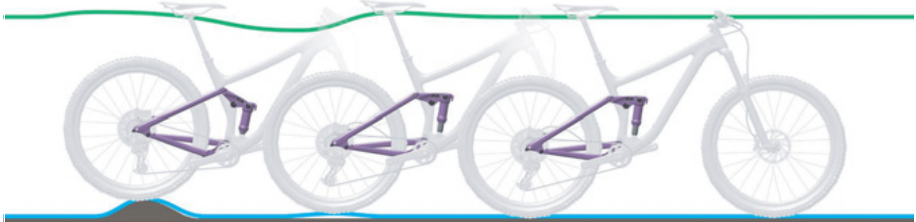
233. ábra: A hátsó lengéscsillapító túl gyors kirugózása
