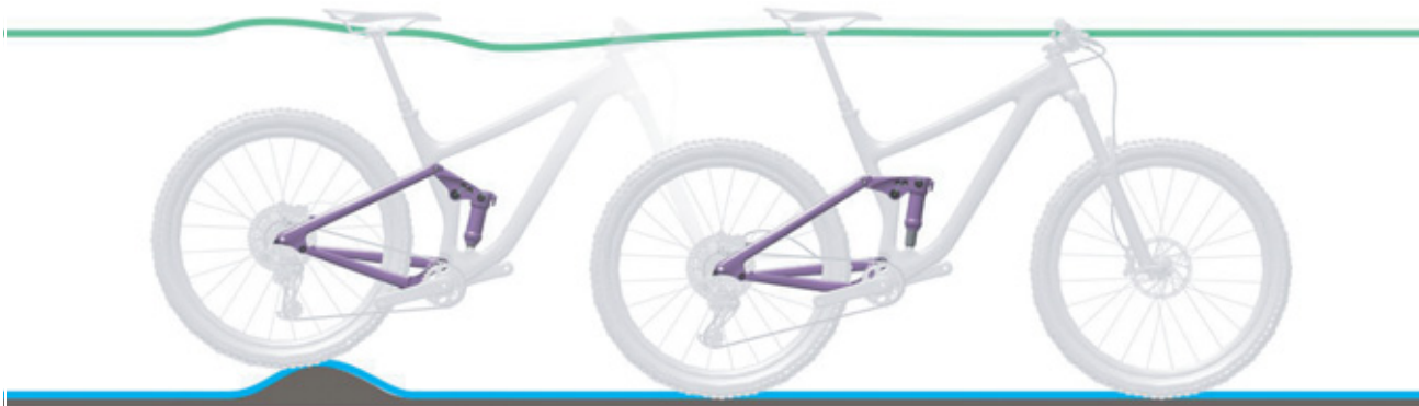
125. ábra: A hátsó lengéscsillapító optimális menetviselkedése egyenetlenségeknél
