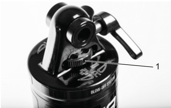
228. ábra: SR SUNTOUR kerék-húzófokozat-beállító (1) a hátsó lengéscsillapítón
