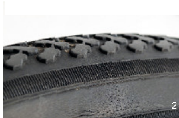
166. ábra: Példák kifáradási repedésekre (1) és öregedési repedésekre (2)
