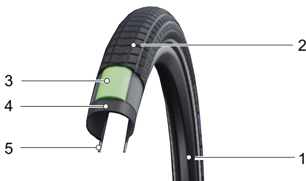
18. ábra: Nyitott gumibroncsok felépítése
