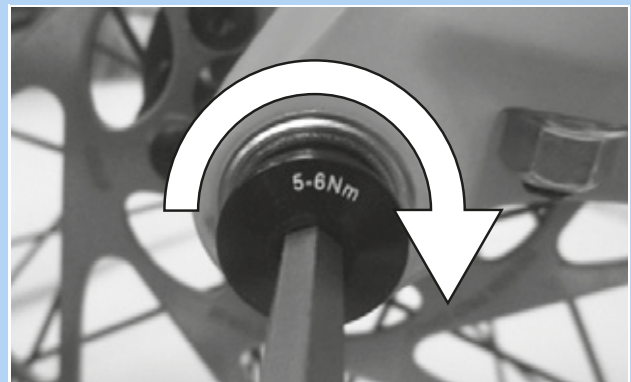
64. ábra: A rögzítőcsavar meghúzása
