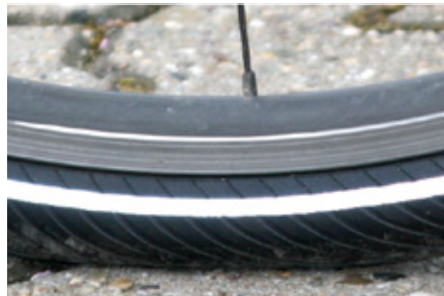
112. ábra: Helyes töltőnyomás. A gumiabroncs alakja a testsúly terhe alatt alig változik
