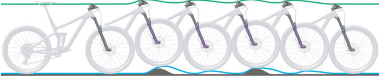
199. ábra: A teleszkópos villa túl gyors kirugózása
