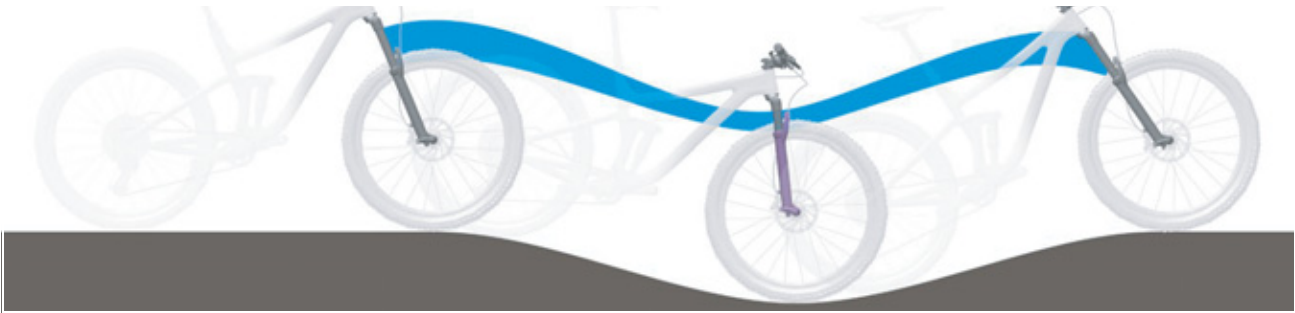
211. ábra: A teleszkópos villa túl puha rugózása hegymenetben
