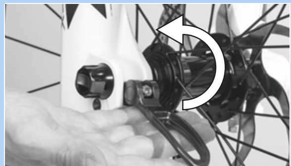
68. ábra: A gyorszár nyomása nyírányban
