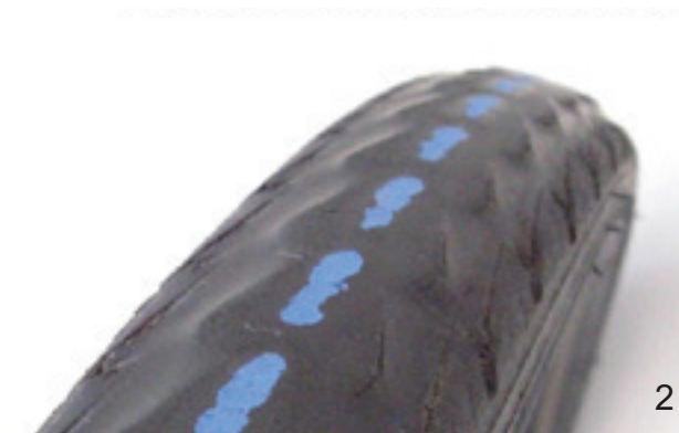
165. ábra: Profil nélküli gumiabroncs, amelyet cserélni lehet (1), és gumiabroncs áttetsző defektvédelemmel (2), amelyet cserélni kell
