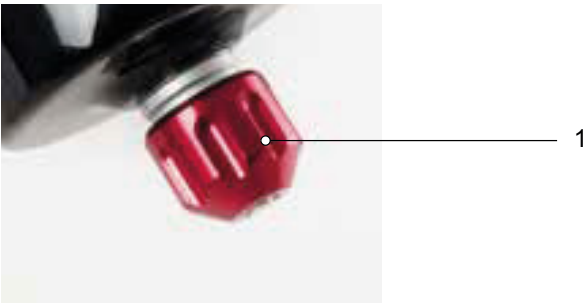
202. ábra: SR SUNTOUR húzófokozat csavar (1)
