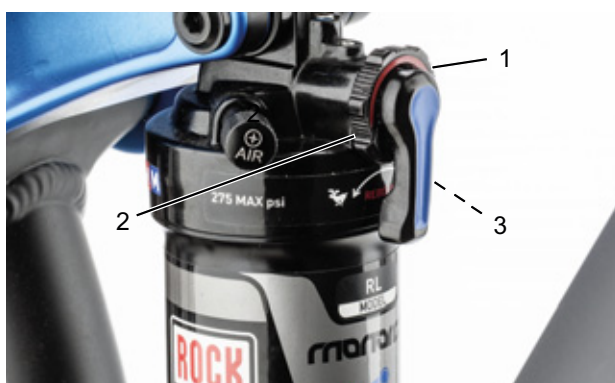
Rysunek 79: Ustawianie twardości tłumika odbicia za pomocą pokrętła regulacyjnego (1)
