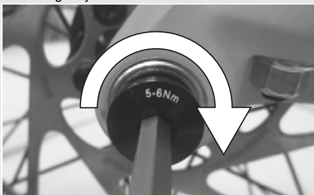
Rysunek 28: Sposób dokręcania śruby zabezpieczającej
