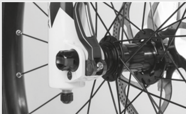
Rysunek 84: Ustawianie siły mocowania zacisku szybkomocującego
