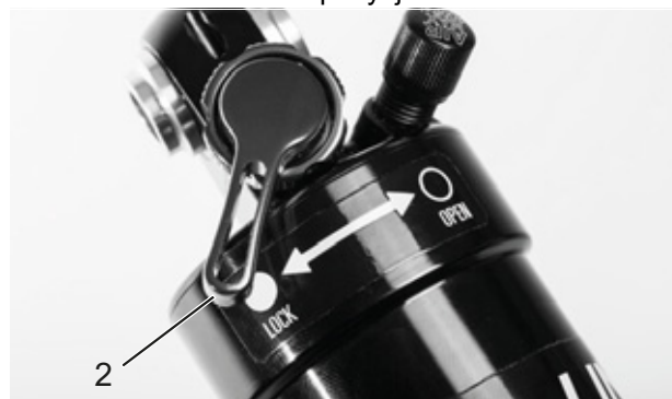
Rysunek 78: Nastawnik dobicia Suntour w pozycji zamkniętej (2)
