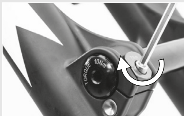
Rysunek 30: Sposób dokręcania osi
