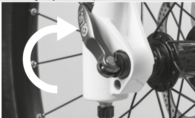
Rysunek 40: Zamykanie zacisku szybko mocującego
