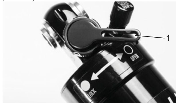
Rysunek 77: Nastawnik dobicia Suntour w pozycji otwartej (1)
