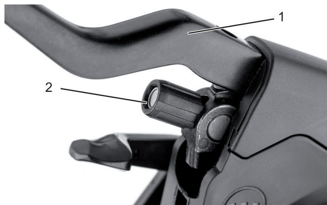
Abbildung 1: Bremshebel (1) der hydraulisch betätigten Felgenbremse mit Einstellschraube (2)
