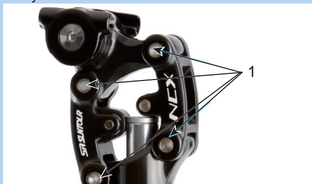
Figur 165: Smørepunkter på SR Suntour affjedret sadelpind
