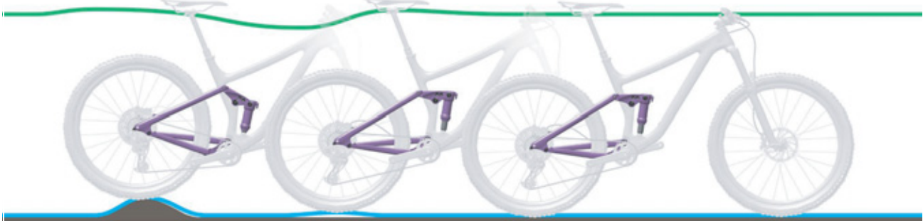
Figur 236: For hurtig tilbagefjedring på bagdæmperen
