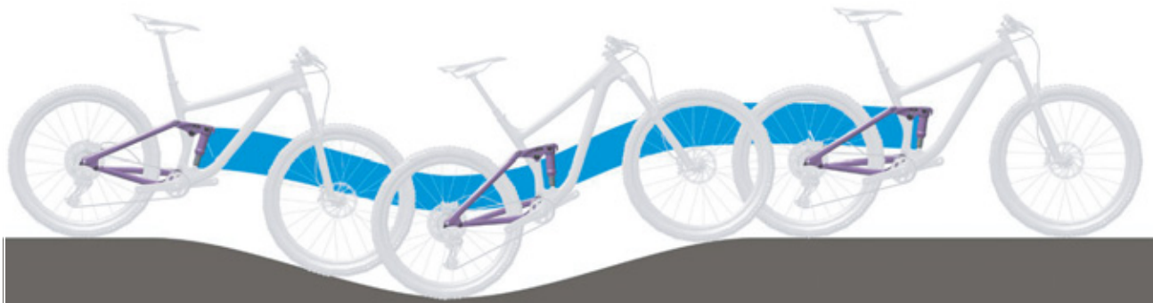
Figur 17: Bagdæmperen fungerer optimalt under kørsel i kuperet terræn
