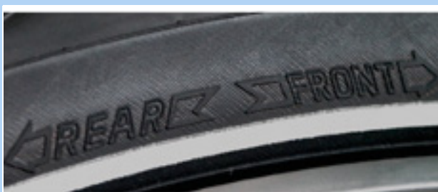
Figur 55: Køreretningspil på MTB-dæk
