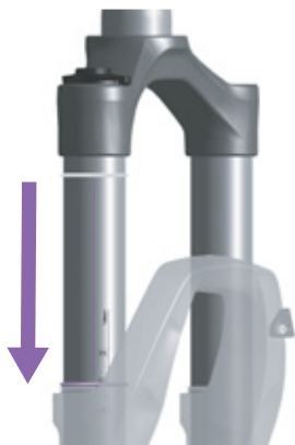
Figur 86: Forskyd O-ringen på fjedergaflen
