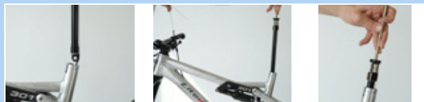
Figur 194: Fastgørelse af patronens ventildæksel
