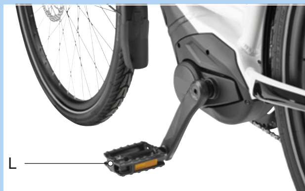
Figur 57: L-pedal i venstre pedalarm
