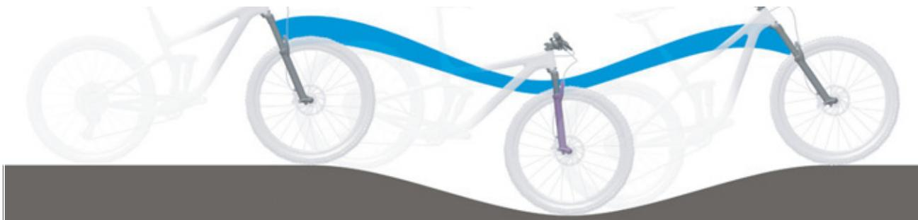
Figura 232: Suspensión de la horquilla de suspensión demasiado blanda en montaña
