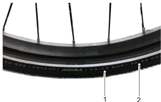
Figura 152: Presión de inflado en bar (1) y psi (2)
