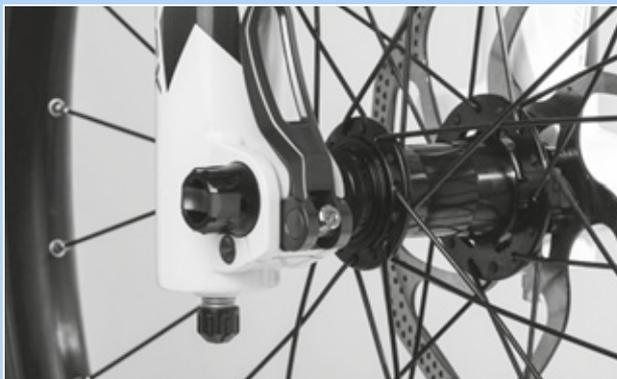
Figura 62: Posición perfecta de la palanca tensora
