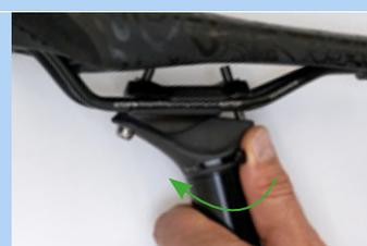
Figura 222: Cierre del ajuste de altura
