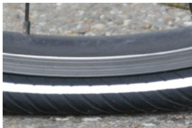
Figura 97: Presión de inflado demasiado baja
