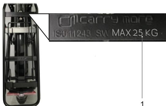
Figura 120: Identificar la capacidad máxima de carga (1) sobre el portaequipajes
