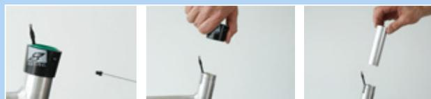
Figura 208: Desmontaje del manguito exterior y del casquillo deslizante
