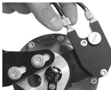
Figura 159: Las versiones de bujes Rohloff con activación de cambio externa tienen los dispositivos de ajuste de tensión en la caja de cables que se encuentra en el lado izquierdo
