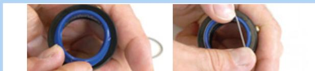
Figura 215: Inserción y fijación del rascador
