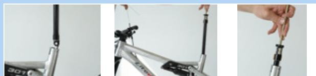
Figura 194: Fijación la tapa de la válvula del cartucho
