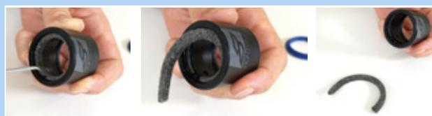
Figura 177: Retirada del anillo de fieltro
