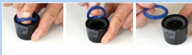
Figura 176: Extracción del rascador
