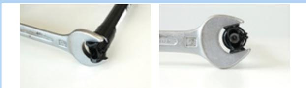
Figura 187: Aseguramiento para evitar el giro
