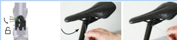
Figura 166: Colocar el accionamiento del ajuste de altura en la "Posición abierta"
