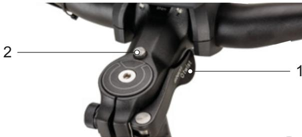
Figura 144: Potencia, versión II con palanca tensora del cierre rápido de la potencia (1) y botón de desbloqueo (2)
