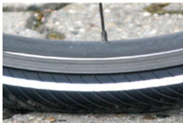
Figura 96: Presión de inflado correcta. La cubierta apenas está deformada bajo la carga del peso corporal
