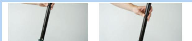
Figura 201: Desplazamiento hacia abajo de la tija de sillín
