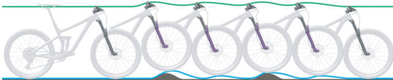
Figura 228: Descompresión demasiado rápida de la horquilla de suspensión
