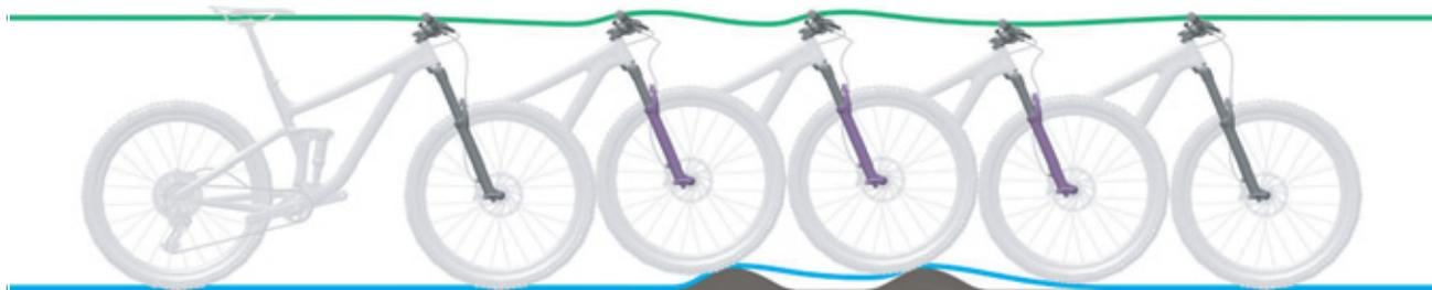
Figura 230: Descompresión demasiado lenta de la horquilla de suspensión
