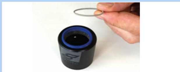
Figura 175: Arandela elástica retirada
