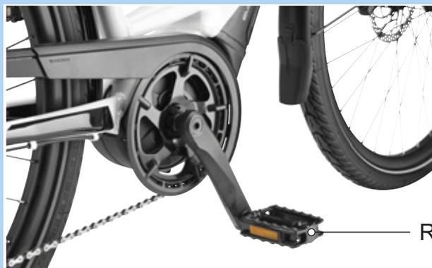
Figura 70: Pedal R en el brazo de manivela derecho
