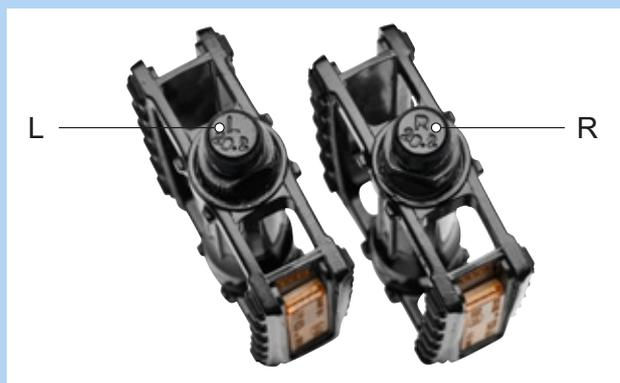
Figura 68: Ejemplo de identificación de los pedales
