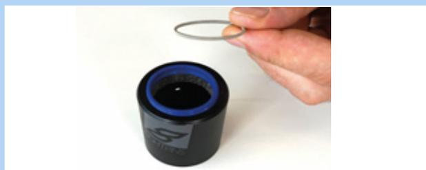
Figura 210: Arandela elástica retirada
