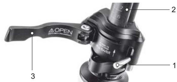
Figura 143: Palanca tensora abierta del cierre rápido de la potencia (3) en la potencia (2), versión I, con palanca de seguridad en la potencia (1)
