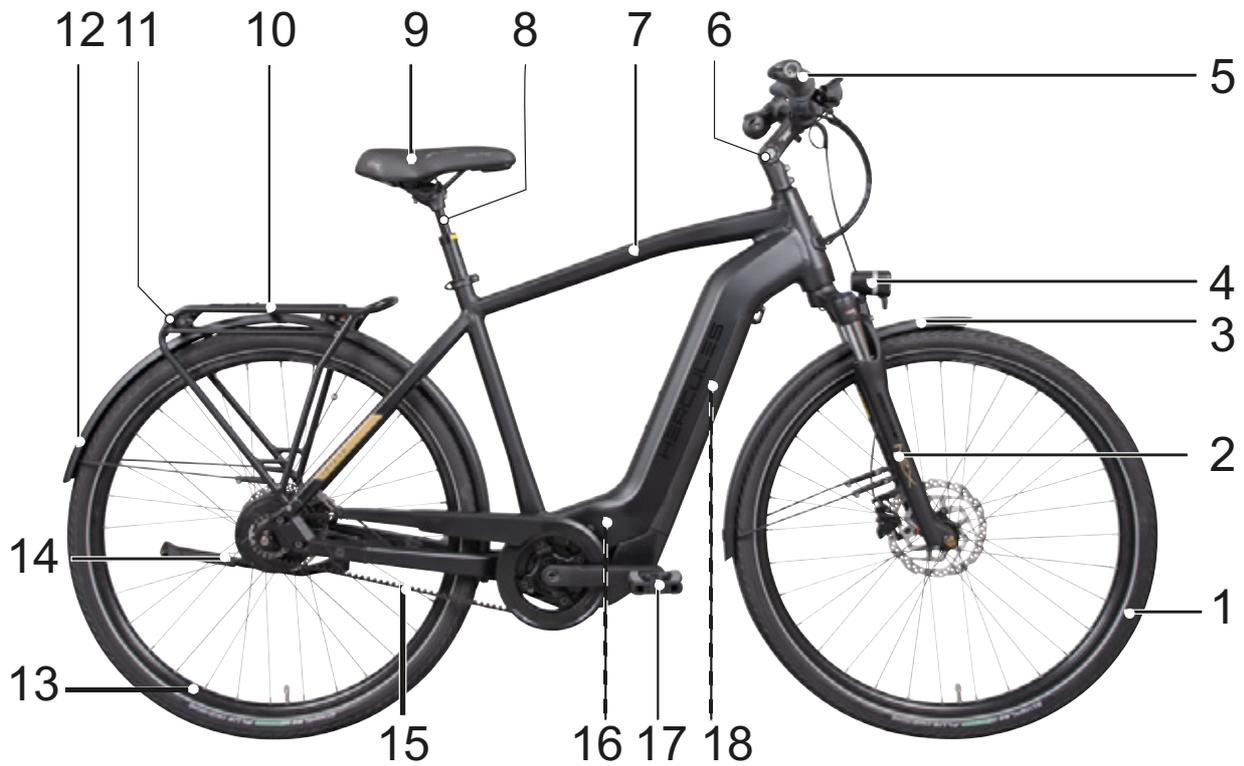
Figura 2: Pedelec visto desde el lado derecho, ejemplo HERCULES Intero I-F5
