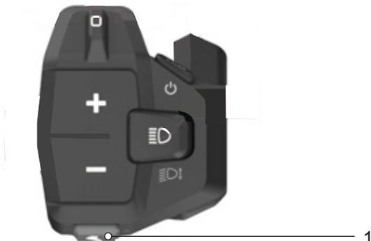
Figura 124: Posición del botón de ayuda para el desplazamiento
