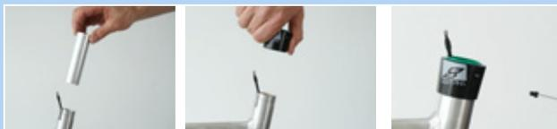
Figura 223: Montaje del casquillo deslizante y del manguito exterior
