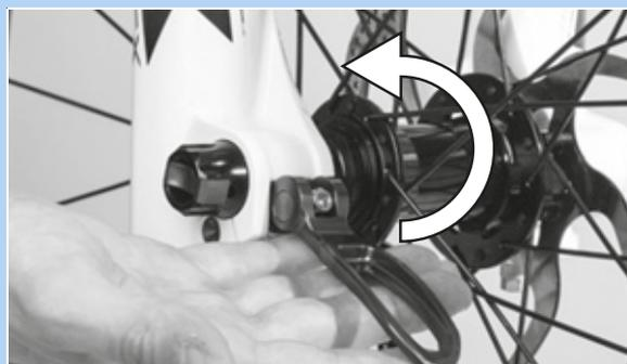
Figura 61: Presión de la palanca de cierre rápido en la dirección de la flecha
