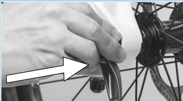
Figura 65: Inserción del cierre rápido en la dirección de la flecha
