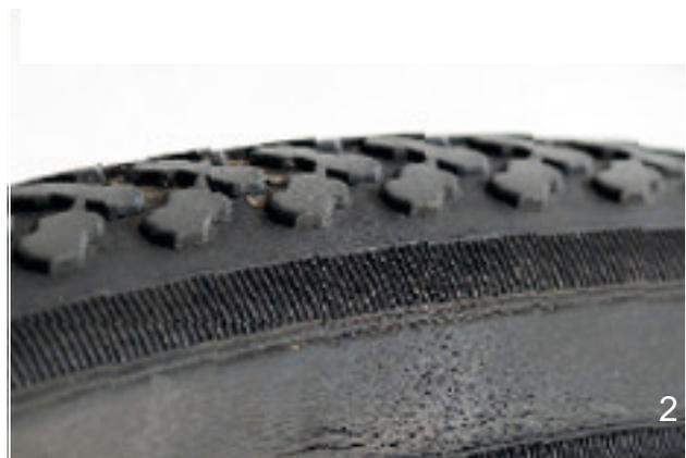
Figura 154: Ejemplos de fisuras por fatiga (1) y fisuras por envejecimiento (2)
