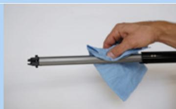
Figura 219: Limpieza de la ranura de guía longitudinal
