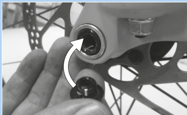
Figura 56: Insección de la palanca de cierre rápido en el eje
