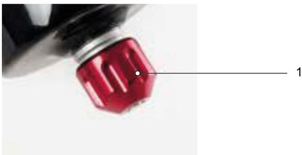
Figura 231: Tornillo de niveles de tracción Suntour (1)
