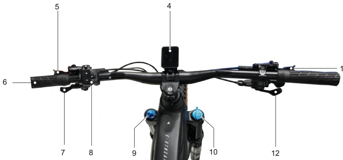
Figura 32: Vista detallada del manillar con ordenador de a bordo BOSCH Intuvia, ejemplo
