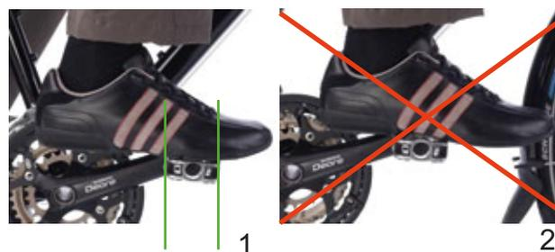
Figura 121: Posición correcta (1) e incorrecta (2) del pie sobre el pedal
