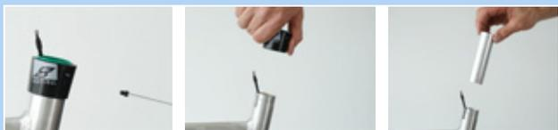
Figura 174: Desmontaje del manguito exterior y del casquillo deslizante
