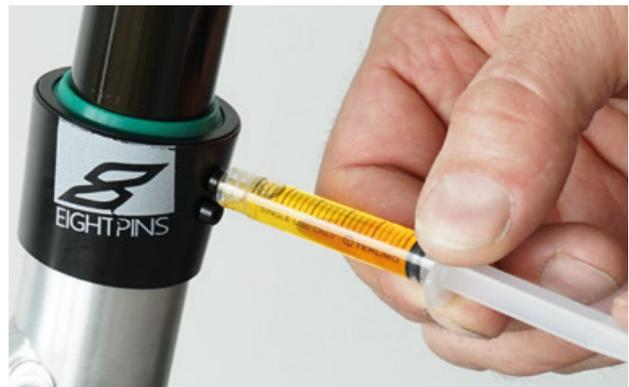
Figura 151: Lubricación del tubo de la tija de sillín
