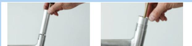
Figura 197: Inserción del tubo del casquillo deslizante en el tubo del sillín
