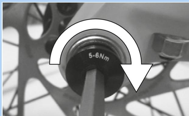
Figura 57: Apriete del tornillo de seguridad
