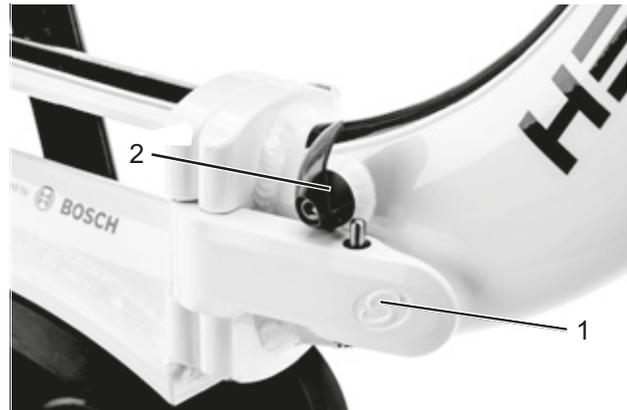
Figura 145: Palanca de seguridad del cuadro cerrada (1) y abierta (2)
