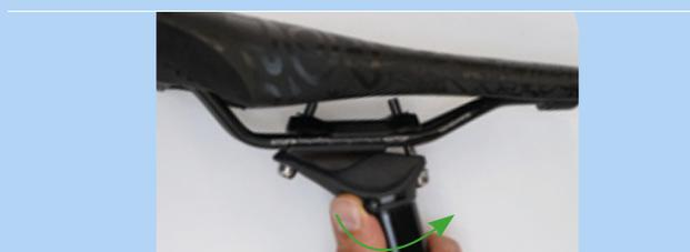
Figura 217: Apertura del ajuste de altura
