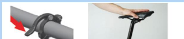
Figura 202: Ajuste de la altura de la tija de sillín
