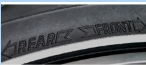
Figura 53: Flecha de sentido de la marcha en cubiertas de MTB
