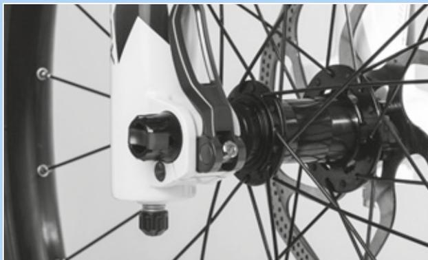
Figura 163: Ajuste de la fuerza de tensado del cierre rápido
