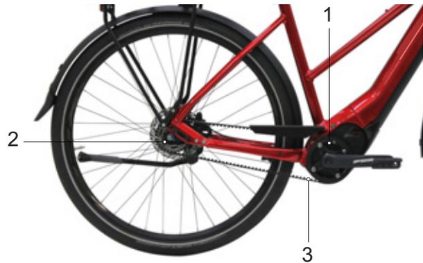
Figura 27: Esquema de la transmisión por correa
