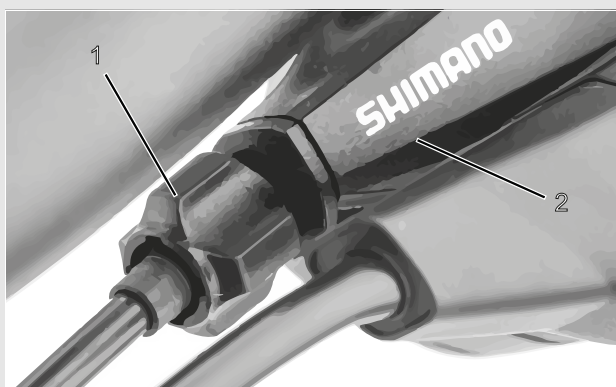
Rysunek 40: Nakrętka regulacyjna (1) jednocięgnowego mechanizmu zmiany przerzutek z obudową dźwigni zmiany biegów (2), przykład
