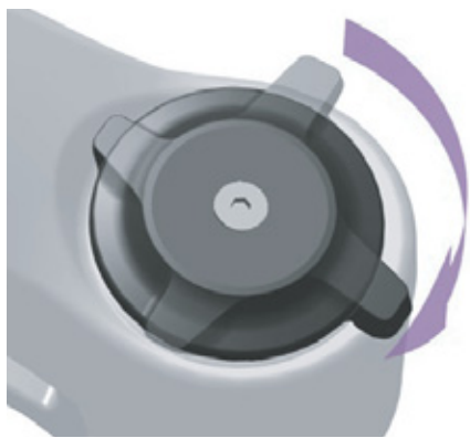
Afbeelding 212: Drukdemperafsteller harder afstellen
