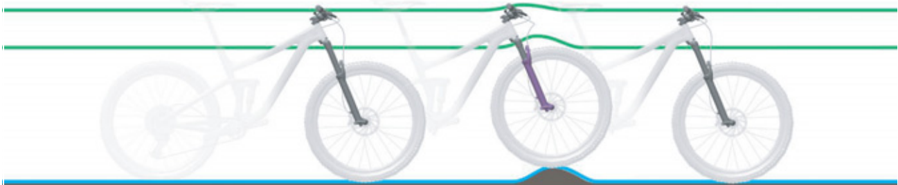
Afbeelding 11: Optimaal rijgedrag van de vork bij oneffenheden
