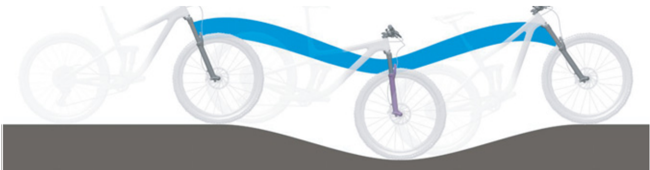
Afbeelding 10: Optimaal rijgedrag van de vork in heuvelachtig terrein
