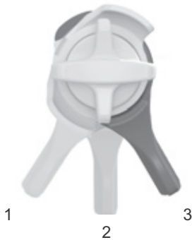
Afbeelding 246: 3-weghendel met standen
