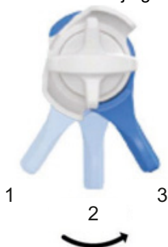
Afbeelding 126: Afstelling van de 3-weghendel van gesloten (1) via midden (2) naar open (3)
