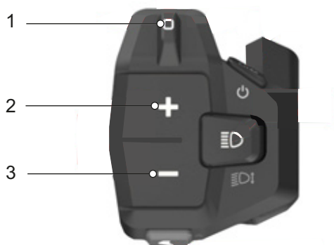
Afbeelding 134: Locatie navigatiewip (1), plus-toets (2) en min-toets (3)
