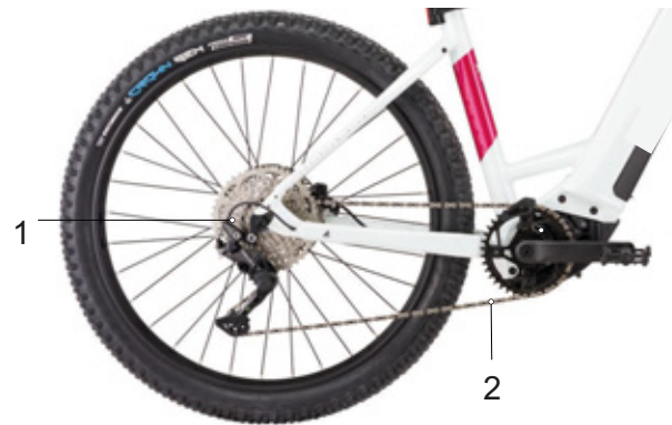
Afbeelding 31: Schema kettingaandrijving met derailleur
