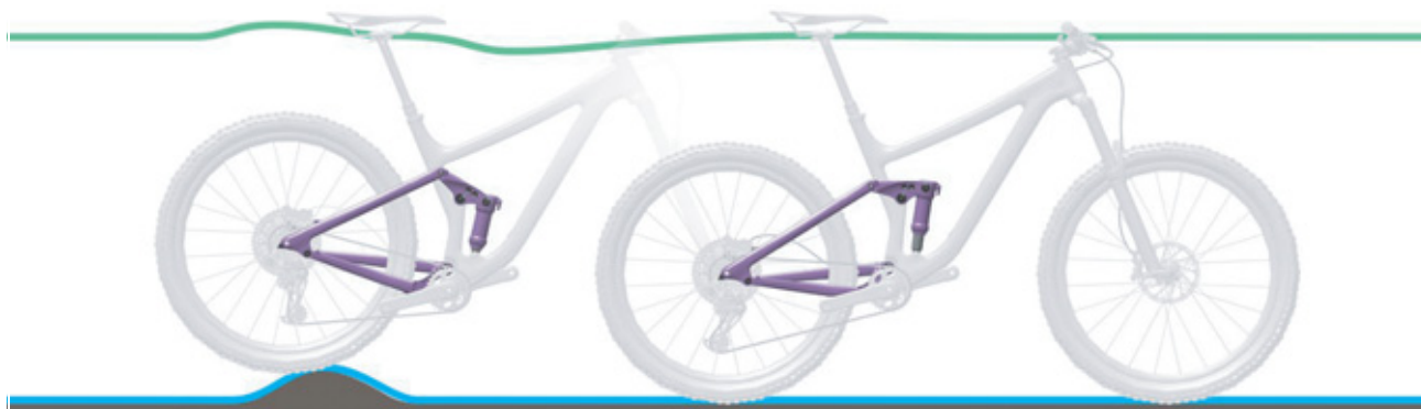
Afbeelding 125: Optimaal rijgedrag van de achterbouwdeemper bij oneffenheden
