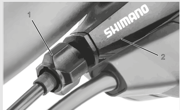
Figura 40: Casquillo de ajuste (1) del cambio de marchas accionado por cable de accionamiento con carcasa de la palanca de cambio (2), ejemplo
