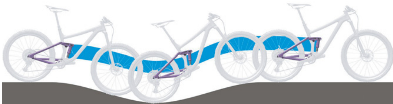
Obr. 68: Optimální chování tlumiče zadního odpružení při jízdě v kopcovitém terénu
