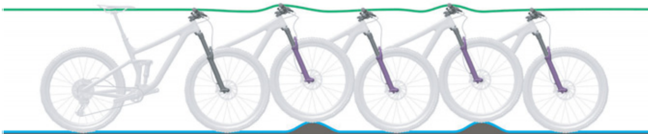
Obr. 5: Optimální chování vidlice při jízdě
