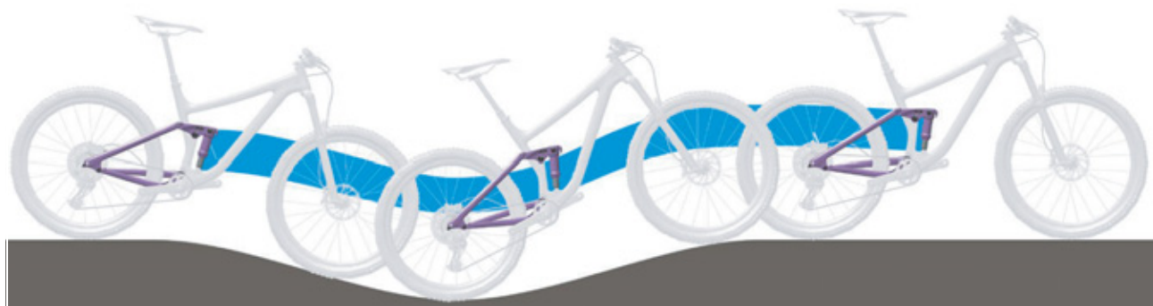
Obr. 11: Optimální chování tlumiče zadního odpružení při jízdě v kopcovitém terénu
