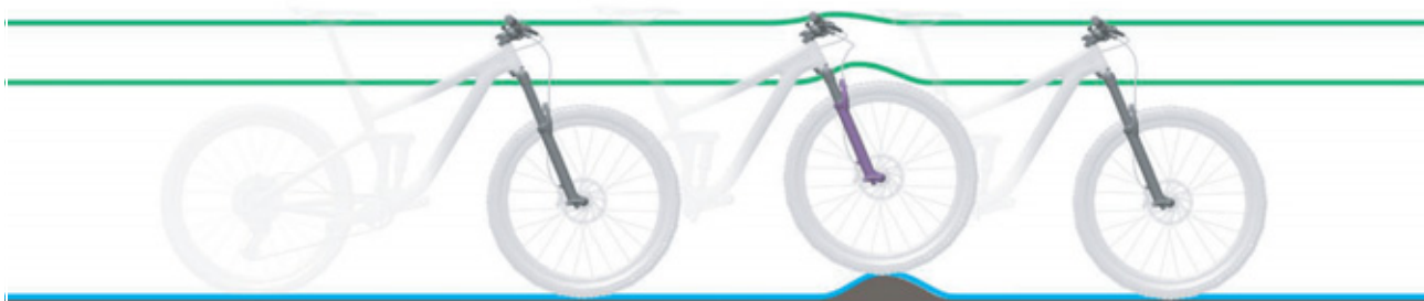
Obr. 7: Optimální chování vidlice při jízdě u nerovností
