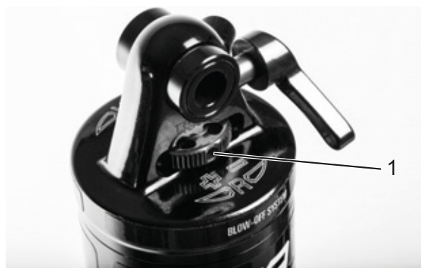
Obr. 64: Nastavovací šroub odskoku Suntour (1) na tlumiči zadního odpružení
