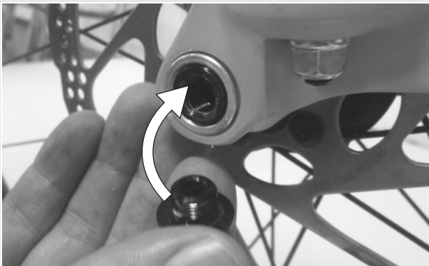
Obr. 24: Zasuňte páku rychloupínáku do osy
