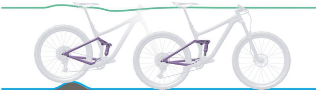
Obr. 69: Optimální chování tlumiče zadního odpružení při jízdě u nerovností
