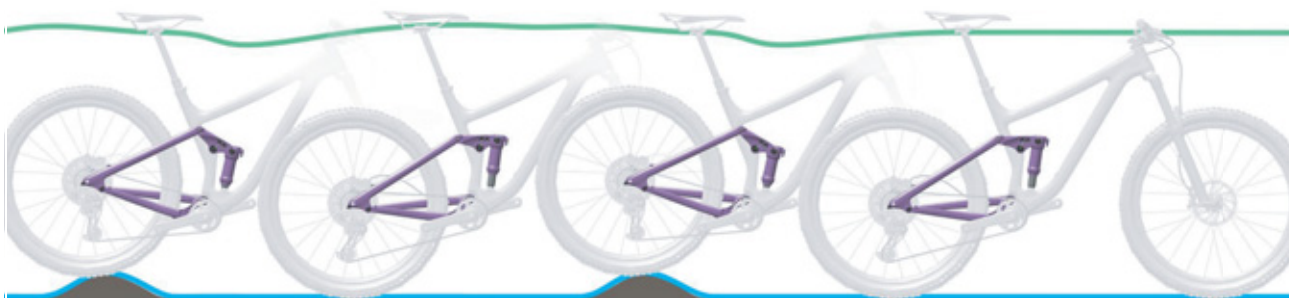
Obr. 62: Optimální chování tlumiče zadního odpružení při jízdě
