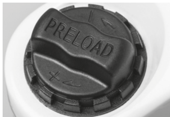
Figur 40: Indstillingshjul for SAG på fjedergaflens gaffelbro
