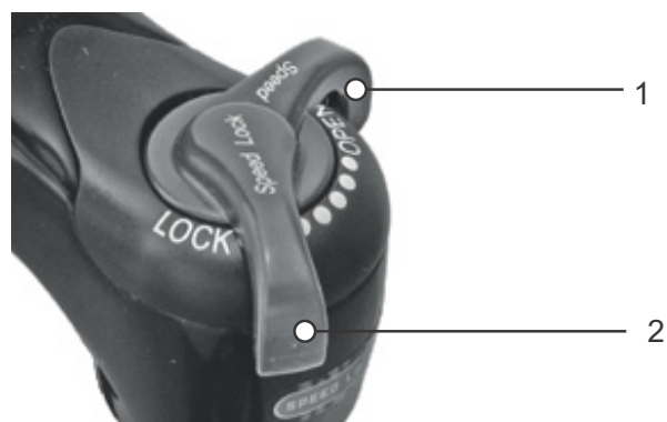
Figur 62: Suntour-trykdæmper i åben (1) og lukket (2) position
