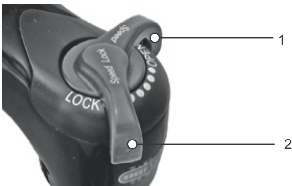
Figur 75: Suntour-trykdæmper i åben (1) og lukket (2) position
