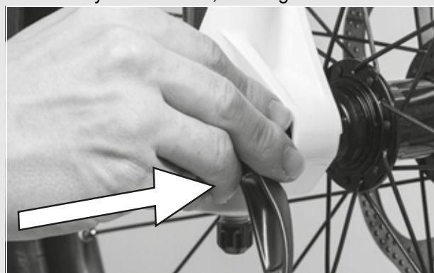
Figur 30: Skub hurtigbespændingen ind
