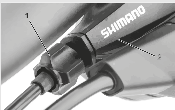
Figur 67: Slutmuffe (1) på gearskiftet med ét kabel og gearvælgerhus (2), eksempel
