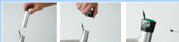
Figura 190: Montaje del casquillo deslizante y del manguito exterior
