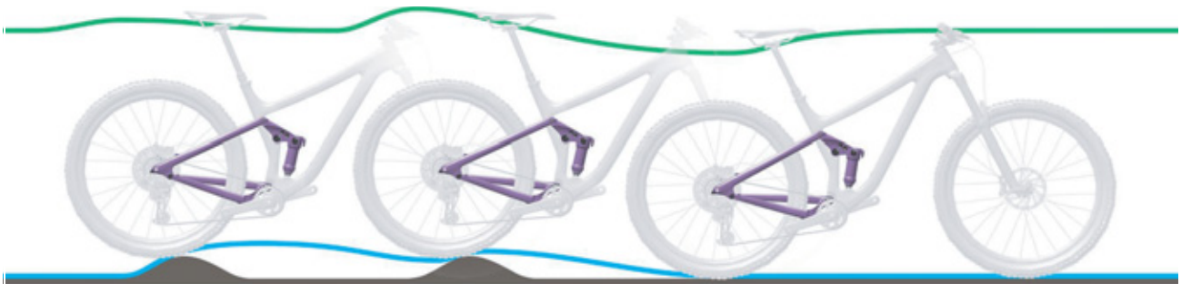
Figura 238: Descompresión demasiado lenta del amortiguador de la horquilla trasera
