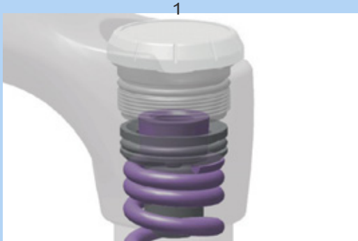
Figura 97: Enroscado y desenroscado del anillo de ajuste de la tensión previa
