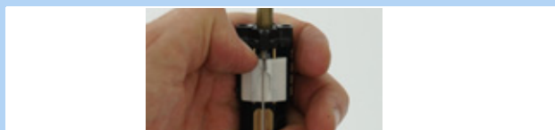
Figura 192: Desplazamiento hacia abajo de la guía deslizante de accionamiento blanca
