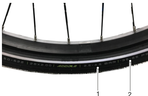
Figura 152: Presión de inflado en bar (1) y psi (2)
