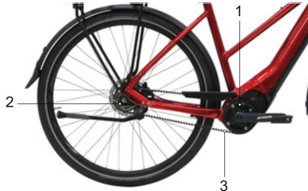
Figura 34: Esquema de la transmisión por correa
