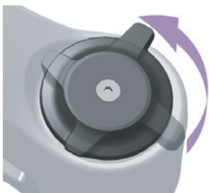
Figura 235: Ajuste para un regulador de niveles de presión más blando
