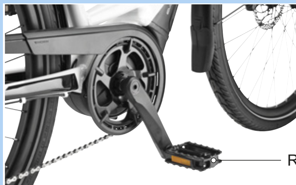
Figura 58: Pedal R en el brazo de manivela derecho
