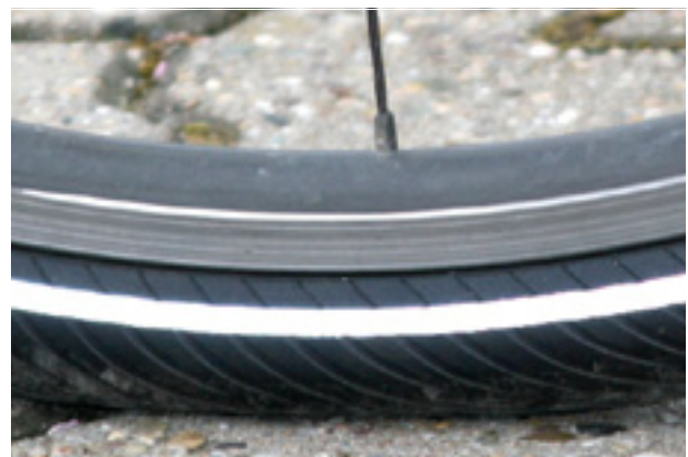
Figura 79: Presión de inflado correcta. La cubierta apenas está deformada bajo la carga del peso corporal
