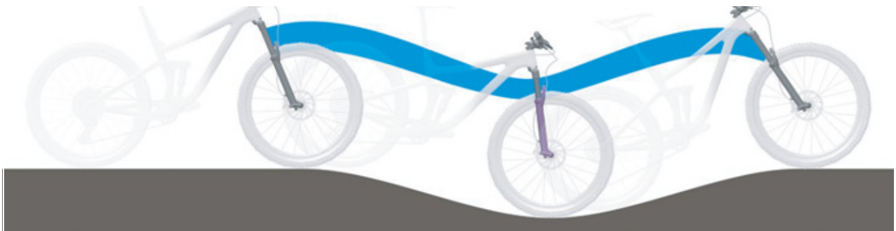
Figura 10: Condición óptima de marcha de la horquilla sobre un terreno accidentado
