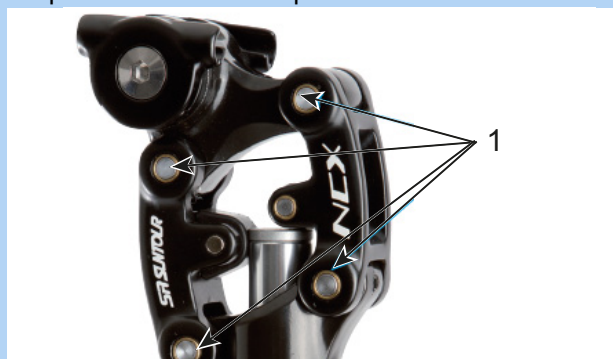
Figura 165: Puntos de lubricación de la tija de sillín de muelle SR Suntour
