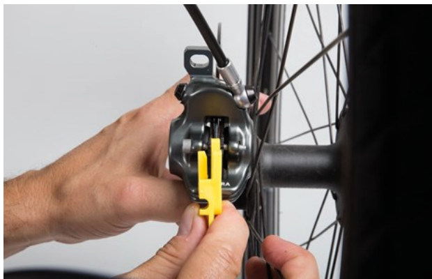
Figura 155: Comprobación de la almohadilla de freno montada con ayuda del seguro de transporte
