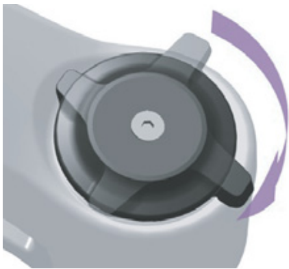
252. ábra: A nyomásfokozat-beállító keményebb beállítása
