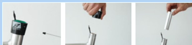
219. ábra: Külső hüvely és siklópersely kiszérése
