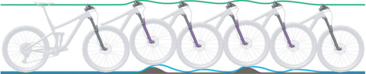
239. ábra: A teleszkópos villa túl gyors kirugózása
