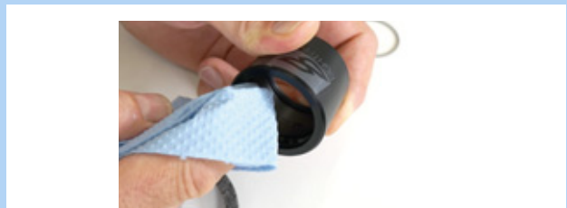
189. ábra: Külső hüvely tisztítása
