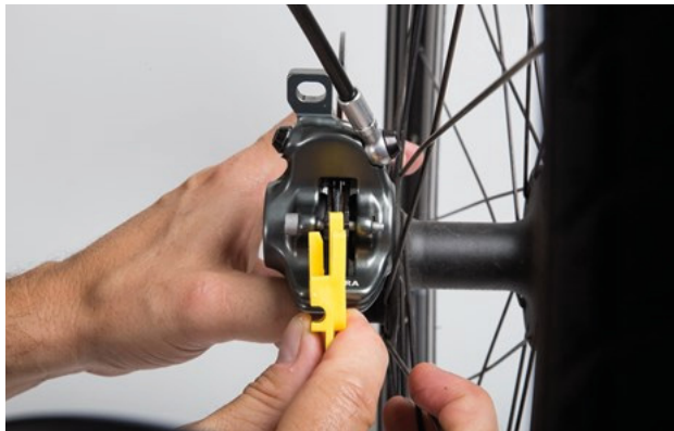
166. ábra: Fékbetét ellenőrzése beépített állapotban a szállítási rögzítés segítségével
