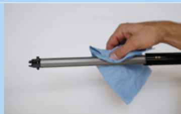
230. ábra: Hosszirányú vezetőhorny tisztítása
