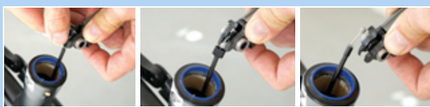
218. ábra: Bovden eltávolítása
