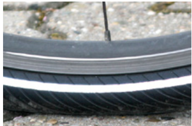
88. ábra: Helyes töltőnyomás. A gumiabroncs alakja a testsúly terhe alatt alig változik
