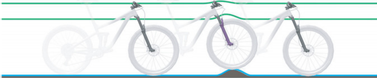
148. ábra: Optimális menetviselkedés egyenetlenségek esetén
