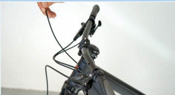
236. ábra: Végsapka beakasztása
