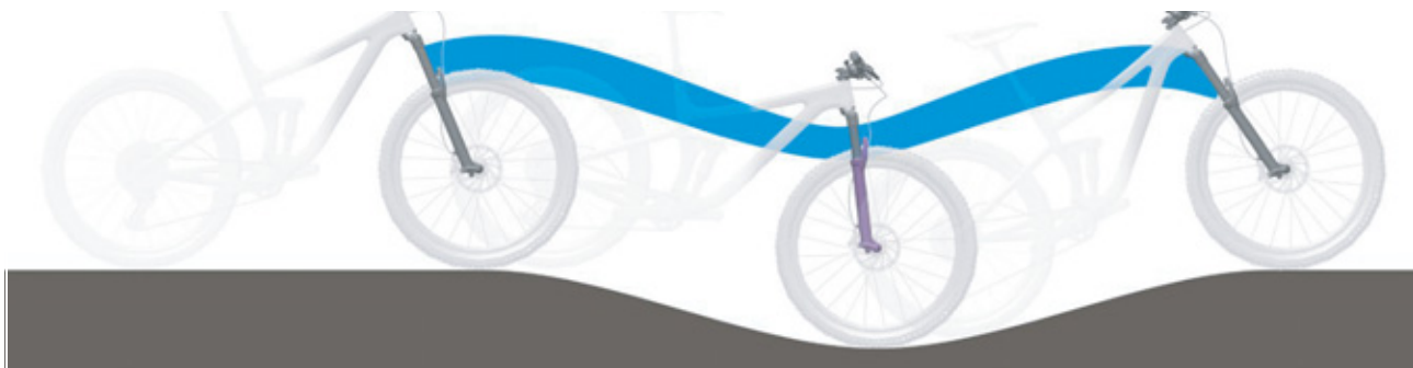
9. ábra: A villa optimális menetviselkedése dombos terepen
