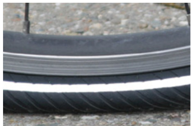
89. ábra: Túlontúl alacsony töltőnyomás
