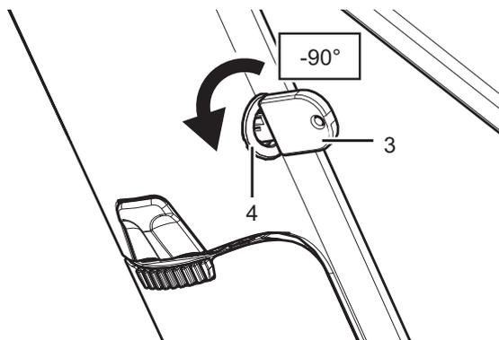
Abbildung 71: Antriebseinheit abschließen
