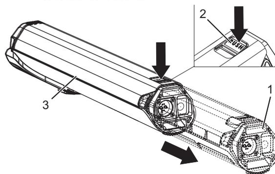
Abbildung 69: Akku aus Antriebseinheit herausnehmen
