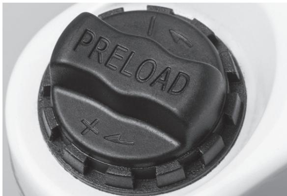
**Abbildung 57: Einstellrad des Negativen Federwegs auf der Krone der Federgabel**
