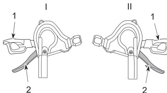
Abbildung 79: Runter-Schalthebel (1) und Hoch-Schalthebel (2) der linken (I) und rechten (II) Schaltung
