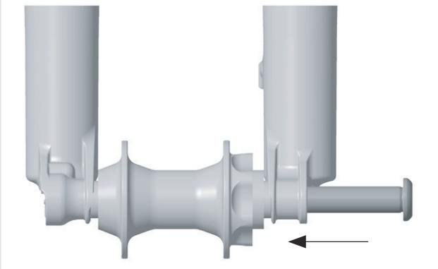
Abbildung 43: Kabolt-Achse einschieben
