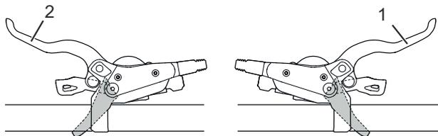
Abbildung 74: Bremshebel hinten (1) und vorne (2), Beispiel Shimano Bremse
