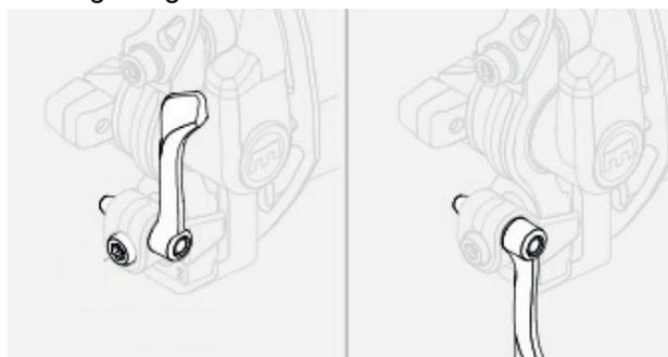
Abbildung 10: Verriegelungshebel der Felgenbremse, geschlossen (1) und geöffnet (2)
