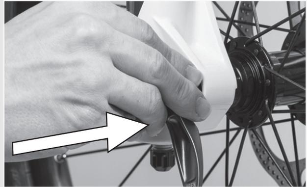
Abbildung 37: Schnellspanner hineinschieben
