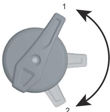
Abbildung 75: FOX-Druckstufeneinsteller mit den Positionen OFFEN (1) und HART (2)
