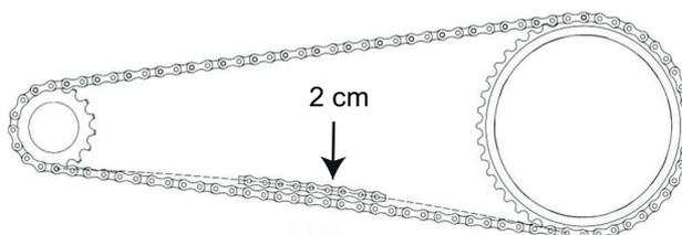
Abbildung 81: Kettenspannung prüfen
