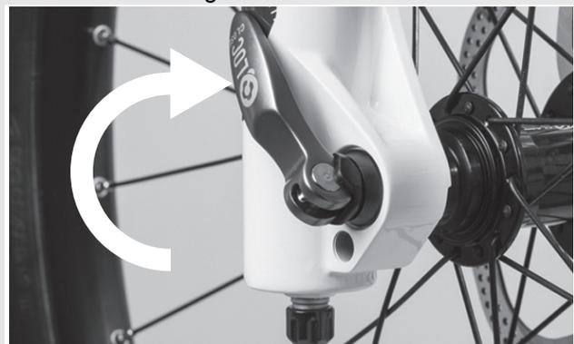
Abbildung 39: Schnellspanner schließen
