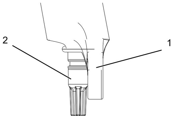
Abbildung 58: Suntour-Zugstufeneinsteller (1) an der Gabel (1)
