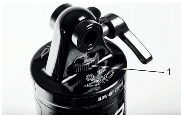
Abbildung 60: Suntour-Zugstufeneinsteller Rad(1) am Hinterbau-Dämpfer
