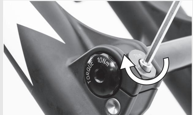
Abbildung 29: Achse anziehen
