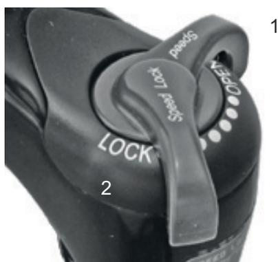
Abbildung 78: Suntour-Druckstufeneinsteller mit den Positionen OPEN (1) und LOCK (2)
