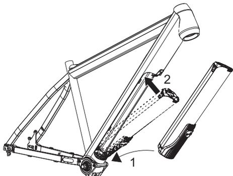
Abbildung 70: Antriebseinheit ins Fahrrad einsetzen
