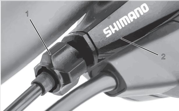
Abbildung 84: Einstellhülse (1) der einzügigen, seilzugbetätigten Gangschaltung mit Schalthebelgehäuse (2), Beispiel
