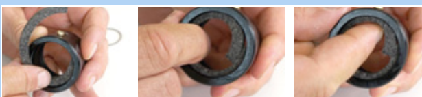
Afbeelding 207: Vilten ring inleggen
