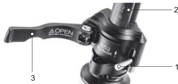
Afbeelding 133: Geopende spanhendel van de snelspanner (3) op de voorbouw (2), uitvoering I, met vergrendelhendel op de voorbouw (1)
