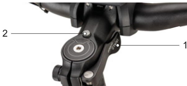
Afbeelding 134: Voorbouw, uitvoering II met spanhendel van de snelspanner van de voorbouw (1) en deblokkeringsknop (2)
