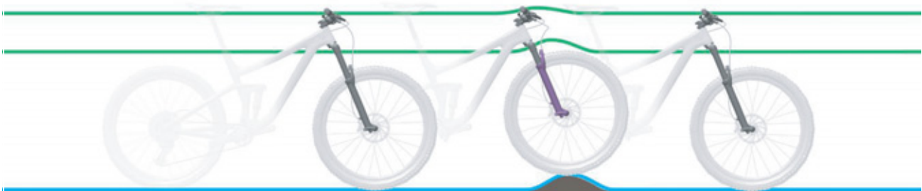
Afbeelding 10: Optimaal rijgedrag van de vork bij oneffenheden
