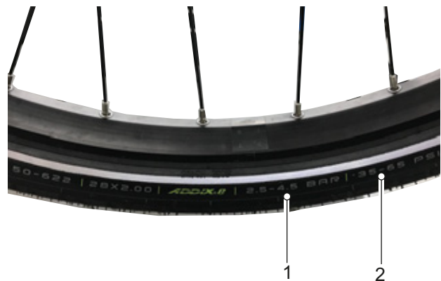
Afbeelding 145: Vuldruk in bar (1) en psi (2)
