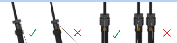
Afbeelding 186: Correcte en verkeerde bowdenkabel
