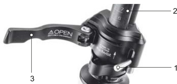
Figura 139: Leva di serraggio (3) del bloccaggio rapido dell'attacco manubrio aperta sull'attacco manubrio (2), versione I, con leva di sicurezza (1) sull'attacco manubrio
