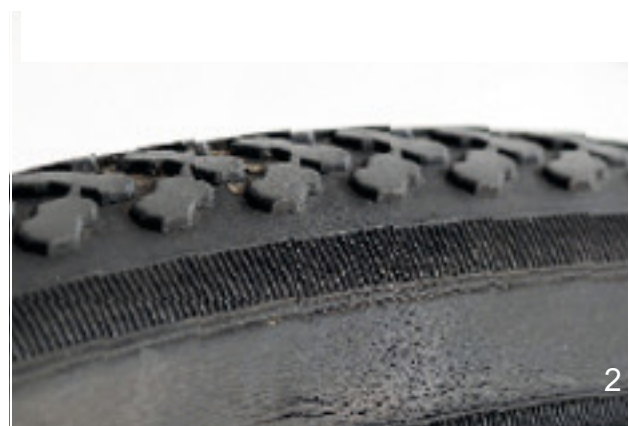
Figura 150: Esempi di crepe da fatica (1) e da invecchiamento (2)
