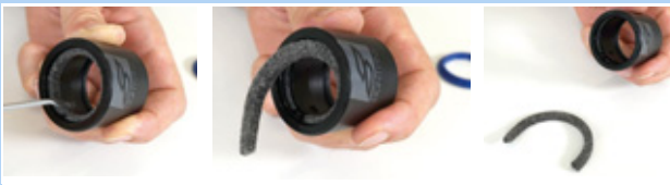
Figura 208: Rimozione dell'anello di feltro
