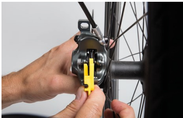
Figura 151: Controllo della guarnizione del freno nello stato montato mediante la sicura di trasporto
