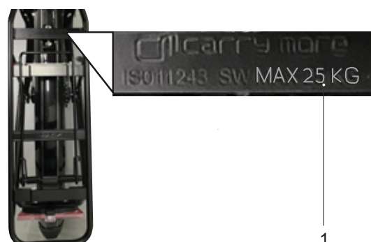
Figura 116: Sul portapacchi è indicata la sua portata massima (1)
