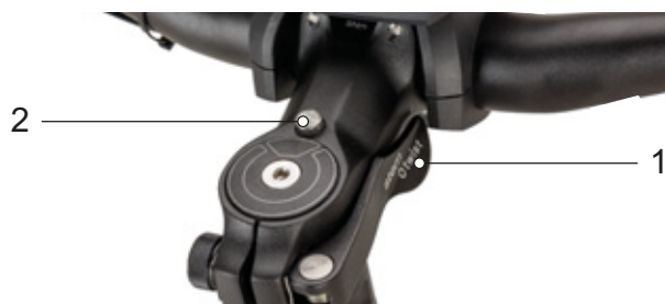
Figura 140: Attacco manubrio, versione II con leva di serraggio (1) del bloccaggio rapido dell'attacco manubrio e bottone di sbloccaggio (2)
