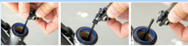
Figura 203: Rimozione del cavo meccanico
