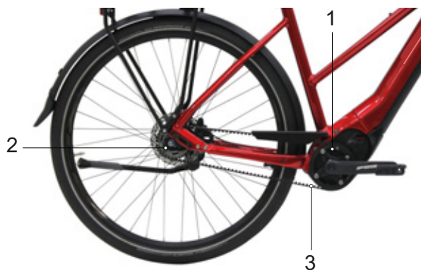
Figura 27: Schema della trasmissione a cinghia
