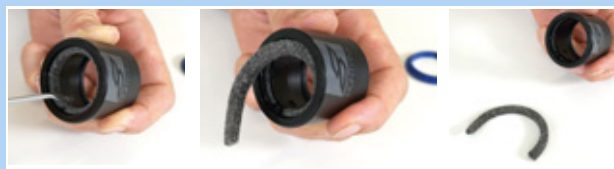
Figura 173: Rimozione dell'anello di feltro
