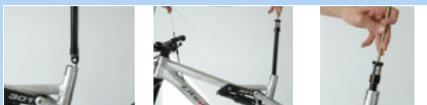
Figura 190: Fissaggio del coperchio della valvola della cartuccia
